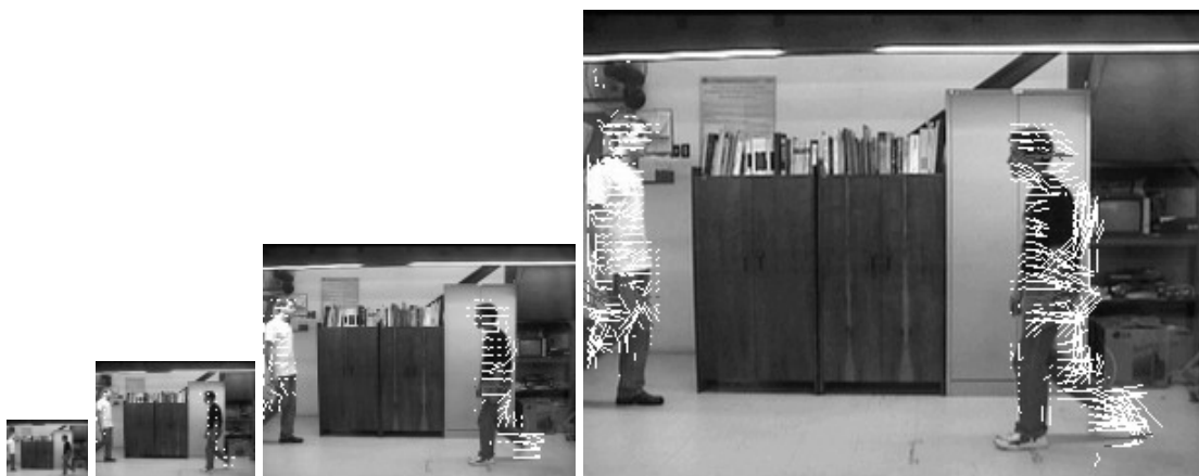
Figura 3.4: Exemplo de detecção de movimento multi-resolução. Aqui a pirâmide é composta por quatro níveis.
