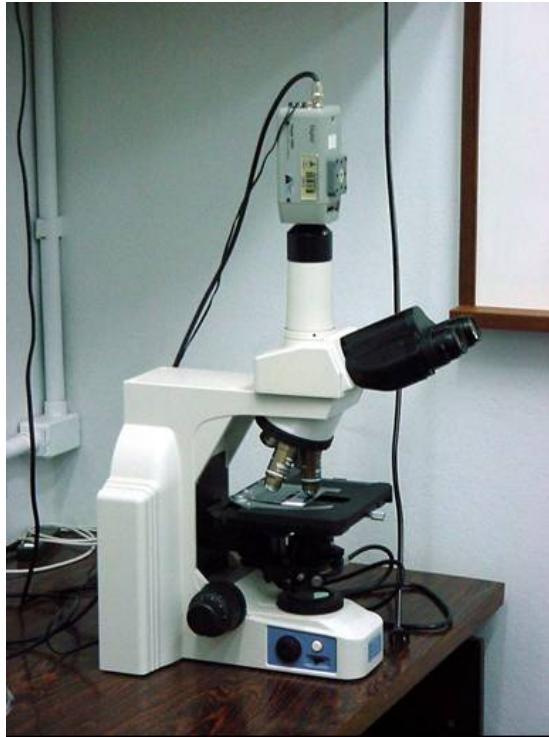
Figura 2 – Parte do sistema de captura de imagem (microscópio e câmera). Faculdade de Veterinária – UFRGS. 2007
