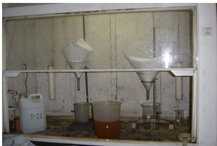
Figura 6: capela para exaustão de gases tóxicos contendo os recipientes de ensaio
