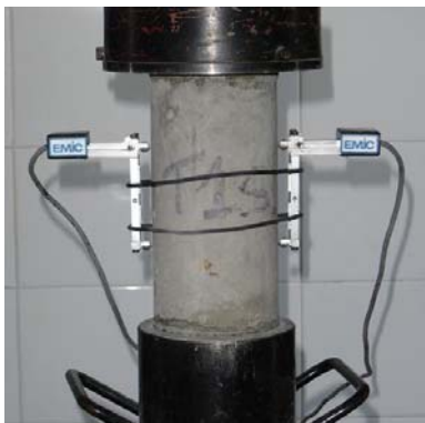
Figura 13: sistema de medição das deformações através de extensômetro eletrônico
