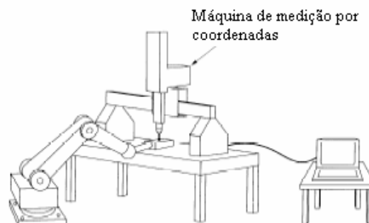
Figura 4.22 – Sistema de medição com uso de máquina de coordenadas [ISO TR, 1995].
