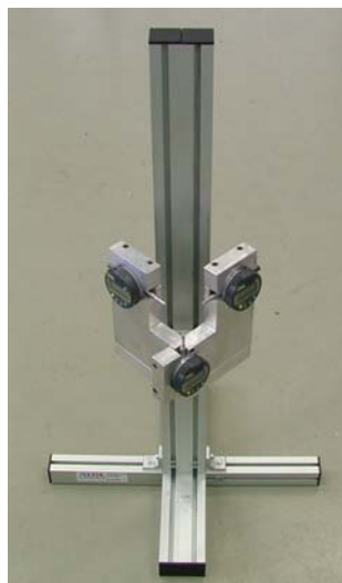
Figura 6.4 – Estrutura de sustentação para dispositivo de medição.
