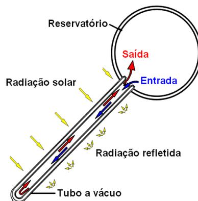
A eficiência deste tipo de coletor é calculada através da razão entre a energia solar incidente sobre o coletor e a energia utilizada para aquecer o fluido de dentro do reservatório (neste caso, a própria água). A norma brasileira que rege os ensaios para a determinação da eficiência de coletores solares é a NBR 15747-2 (ABNT, 2009). Porém, como o tempo de ensaio depende da constante de tempo do coletor, é necessária a utilização da norma americana ASHRAE 93-2003 (ASHRAE, 2003).
