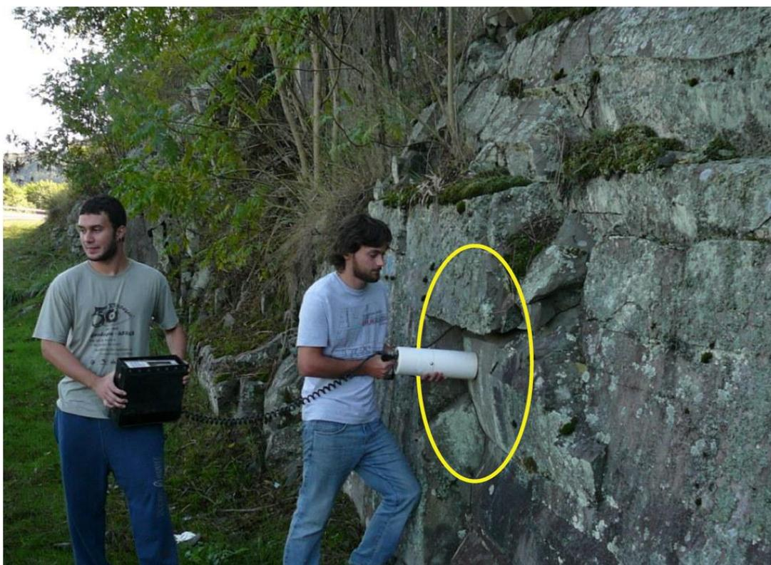
Figura 2 – Medição com o gamaespectrômetro em afloramento, com toda a área da extremidade do detector em contato com uma superfície plana. A resolução do aparelho está exemplificada em amarelo (cerca de 50 cm de raio a partir da extremidade do detector).
