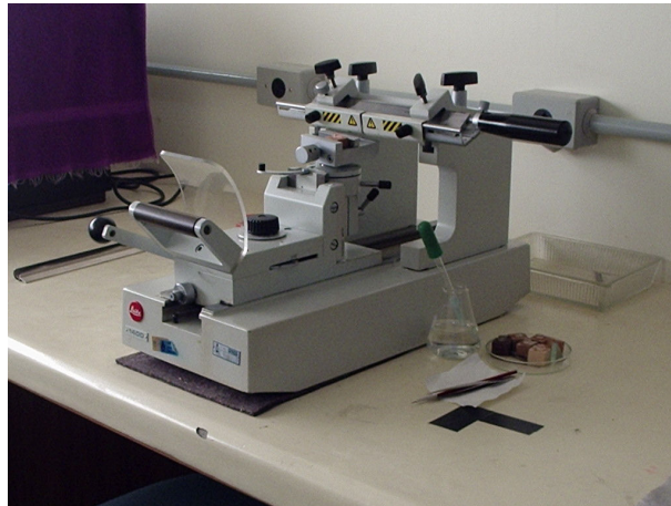
Figura 4. Micrótomo de guias, modelo Leitz, usado para a realização dos cortes histológicos.
