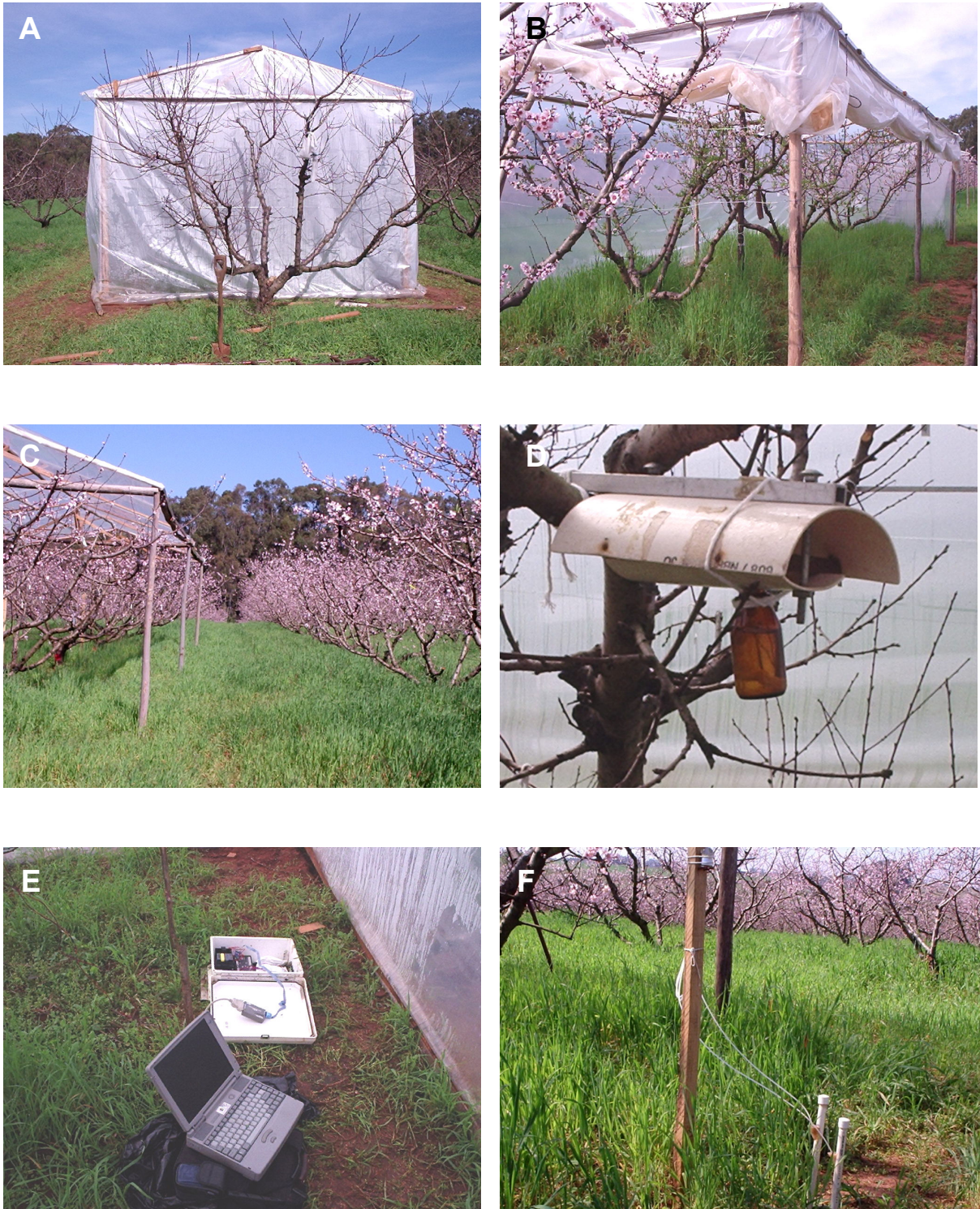
Figura 1. Detalhes da montagem dos tratamentos e do monitoramento micrometeorológico: ambiente protegido (estufa tipo “capela”) (A); sistema de levantamento das cortinas laterais (B); cobertura das plantas (C); psicrômetro (D); sistema de coleta e armazenamento de dados (E); conjunto de tensiômetros (F).
