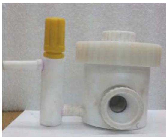
Figura 24. Reator fotocatalítico utilizado nas reações de Water-splitting.
