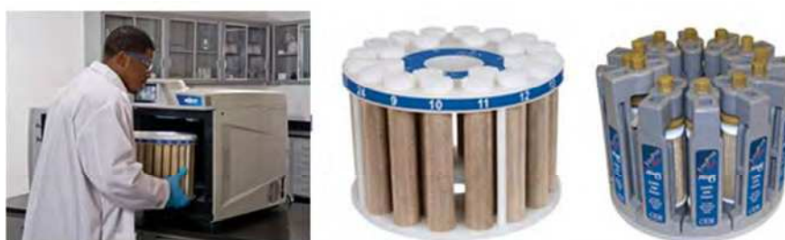
Figura 8. Equipamento de micro-ondas da empresa CEM Corporation multimodo MARS 6. No centro o rotor e reatores do tipo Xpress e a direita o rotor e reatores do tipo Easyprep.
