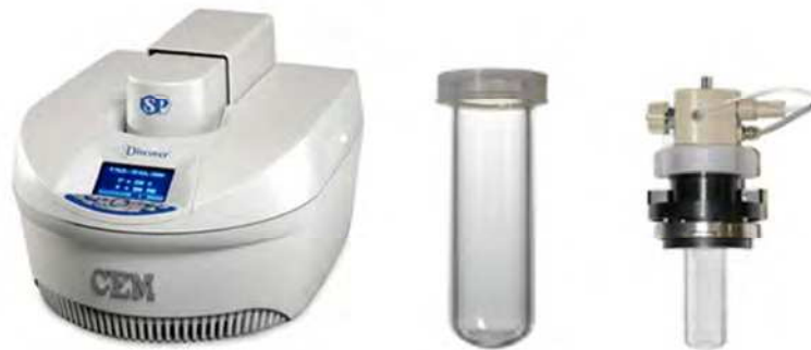
Figura 7. Equipamento de micro-ondas científico da empresa CEM Corporation monomodo Discover. No meio o reator fechado apenas com a tampa polimérica e mais a direita, selado com a unidade metálica.
