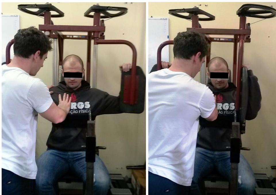
Visando manter o sujeito estável e bem posicionado, velcros foram utilizados ao redor do tórax para fixar o sujeito ao equipamento, e um apoio externo, dado pelas mãos do pesquisador, era realizado para evitar qualquer movimentação compensatória com o lado oposto (ver foto).
