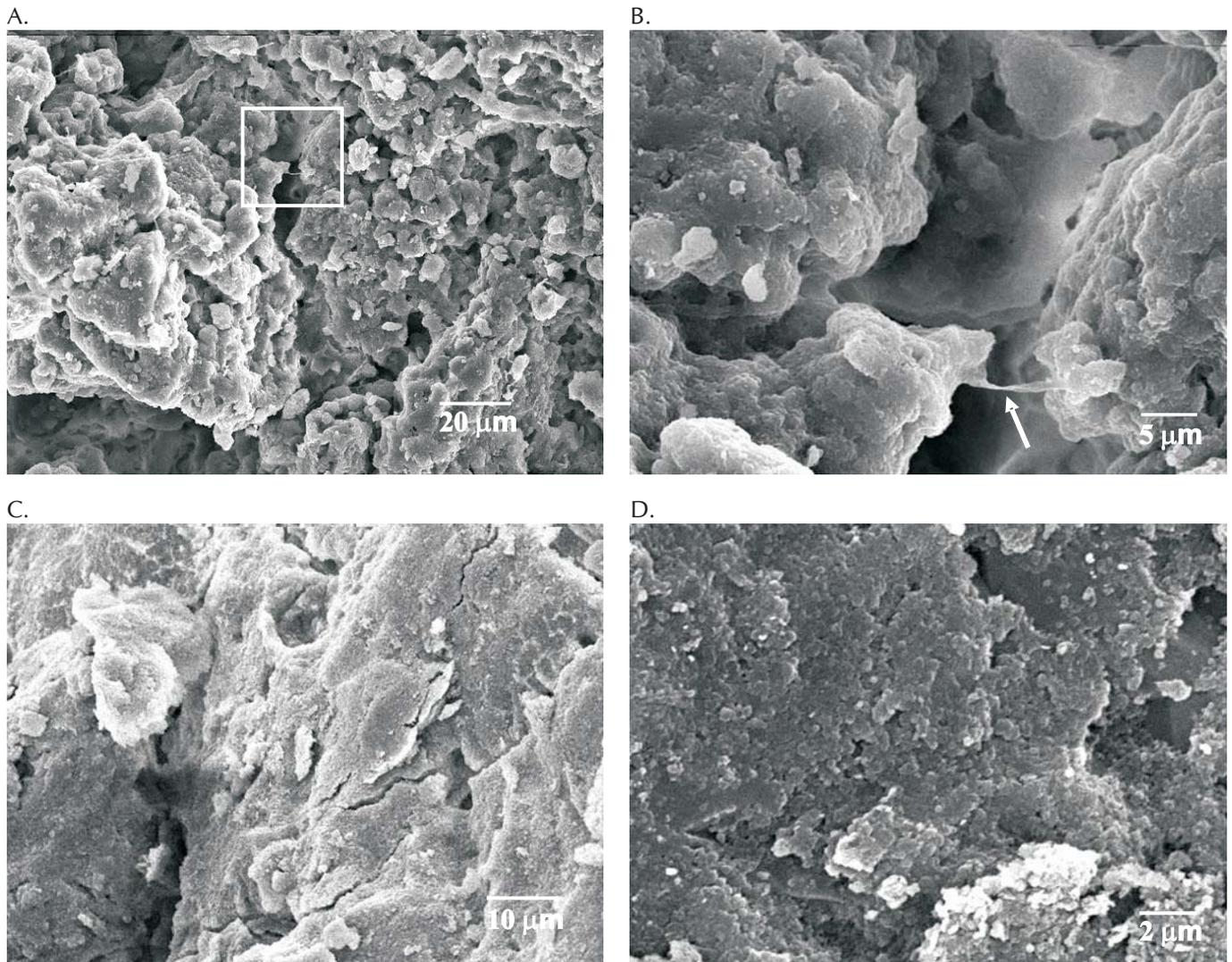
**Figura 5.** Micrografias obtidas com microscópio eletrônico de varredura (MEV), camada de 0-0,2 m. (A) solo da mata, estrutura porosa; (B) ampliação da foto "A", agentes ligantes unindo partículas tamanhos silte e argila (seta); (C) solo sob sequeiro, agregado com orientação de partículas e aspecto adensado; (D) solo com vinhaça, agregado com orientação de partículas de argila
