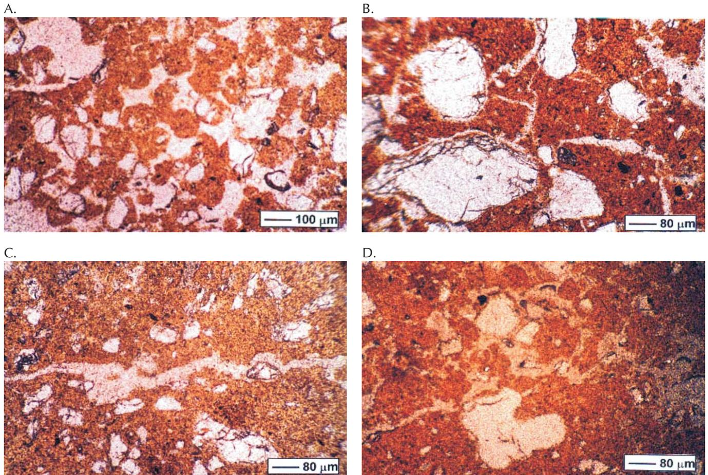
**Figura 2.** Micrografias obtidas com microscópio óptico, camada de 0,2-0,4 m. (A) solo da mata, estrutura granular; (B) solo sob sequeiro, estrutura em blocos angulares; (C) solo irrigado, matriz com aspecto maciço e poro alongado; (D) solo com vinhaça, estrutura em blocos subangulares
