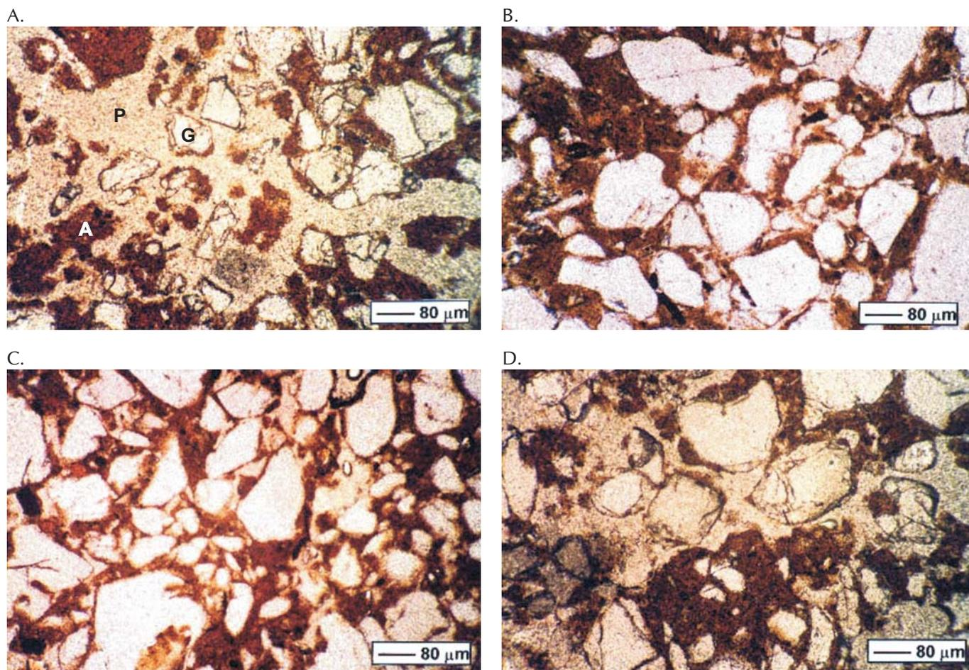
**Figura 1.** Micrografias obtidas com microscópio óptico, camada de 0-0,2 m. (A) solo sob mata nativa, porosidade elevada; (B) solo sob sequeiro, espaço poroso reduzido; (C) solo irrigado, redução do espaço poroso; (D) solo com vinhaça, matriz com aspecto menos compactado. Legenda: P – poro; G – grão de areia; A – agregado
