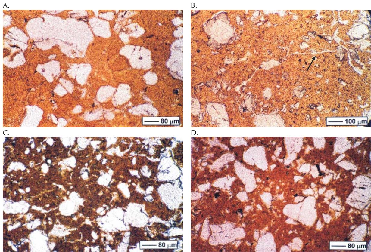
**Figura 3.** Micrografias obtidas com microscópio óptico, camada de 0,4-0,8 m. (A) solo da mata, matriz com aspecto maciço; (B) solo sob sequeiro, poros tipo fissuras (seta); (C) solo irrigado, poros fissurados; (D) solo com vinhaça; matriz com aspecto maciço
