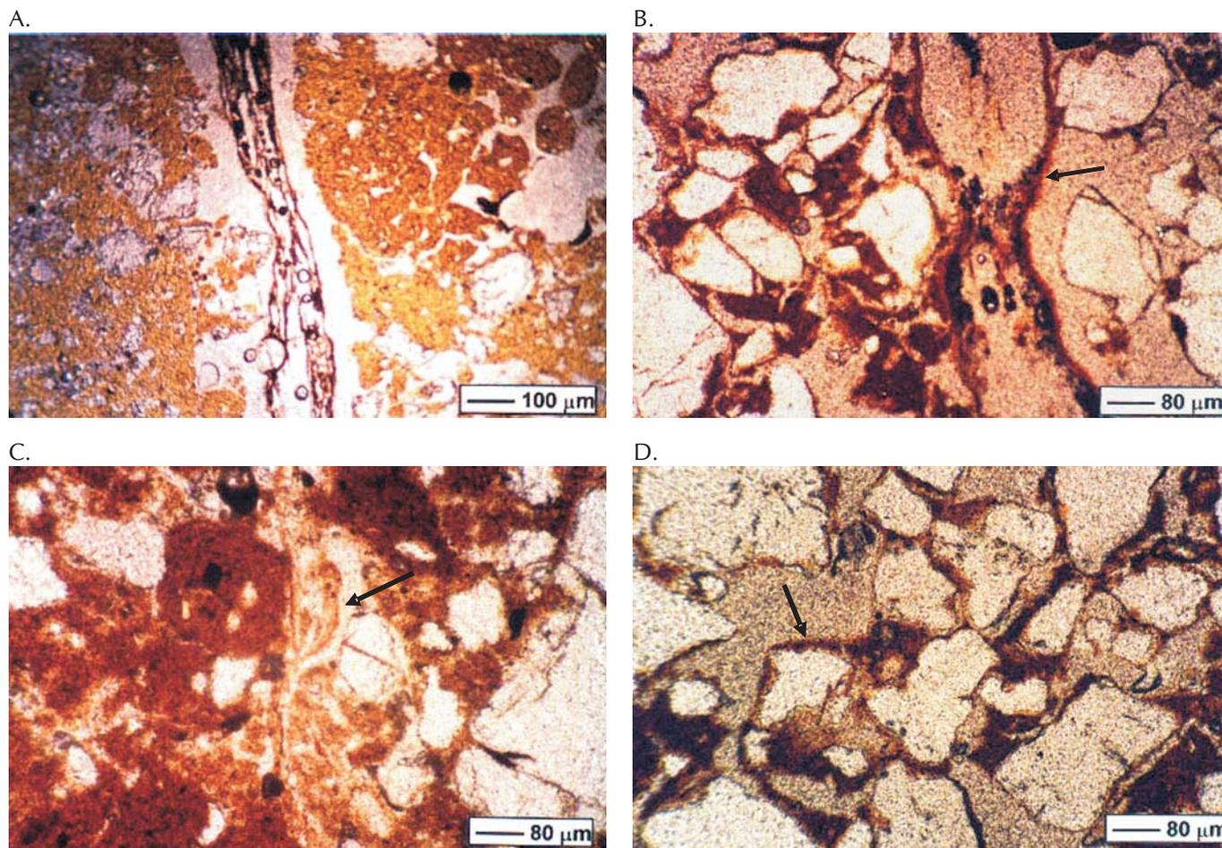
**Figura 6.** Micrografias obtidas com microscópio óptico. (A) solo da mata (0-0,2 m), bioporo; (B) solo sob sequeiro (0-0,2 m), fração mais fina do solo com aspecto típico de migração através de bioporo (seta); (C) solo irrigado (0-0,2 m), feição com aspecto de migração de partículas nos poros (seta); (D) solo com vinhaça (0,2-0,4 m), fração mais fina revestindo a superfície de grãos de areia (seta)
