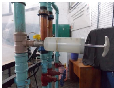
Injeção acoplada na tubulação do modelo físico
