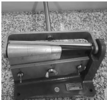
Figura 11. Amostra (painel pintado) submetida ao ensaio de flexibilidade.
