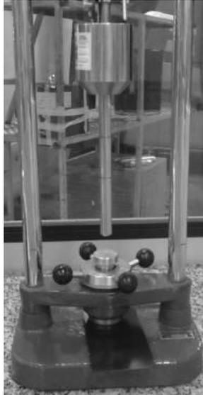
Figura 10. Amostra (painel pintado) submetida ao ensaio de impacto.
