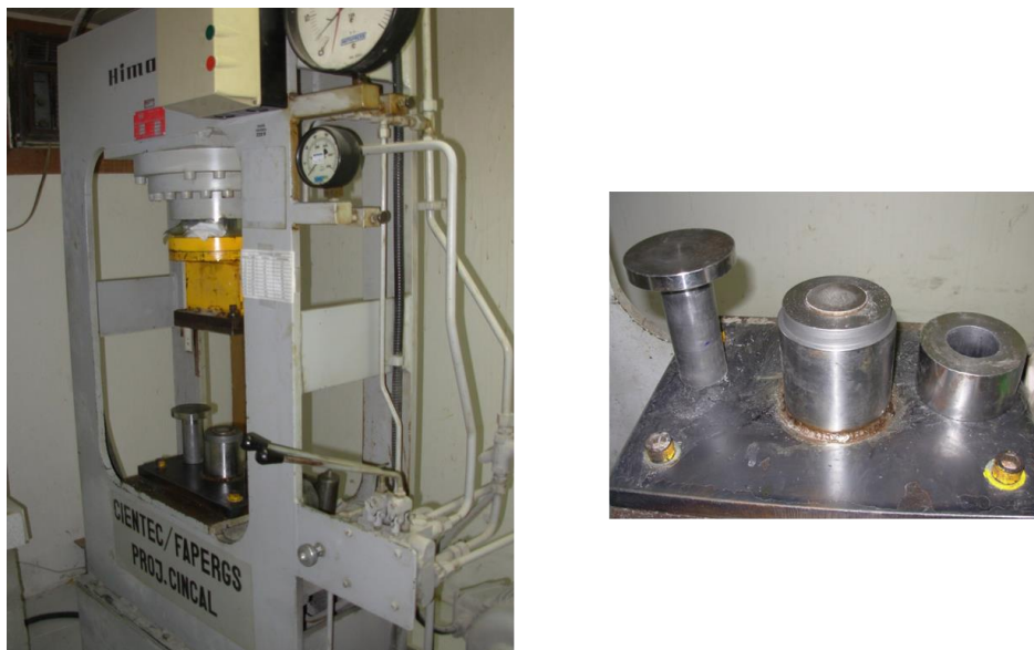
Figura 17 – Prensa e molde adaptado para confecção dos corpos-de-prova.
