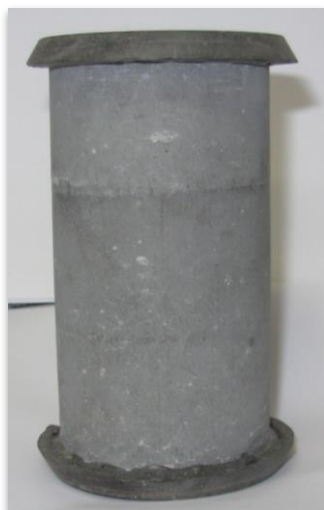
Figura 19 – Aspecto do corpo de prova curado e capeado.
