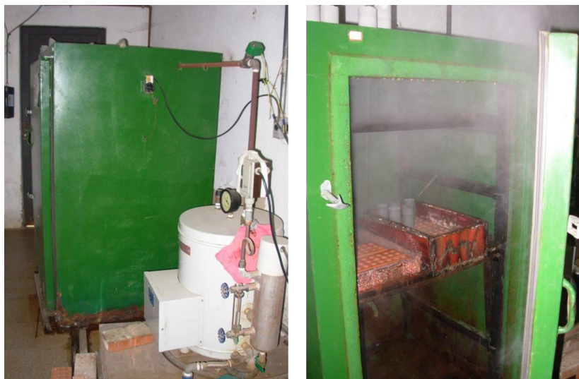
Figura 18 – Câmara de vapor utilizada para cura dos corpos-de-prova em temperaturas de 40°C, 60°C e 80°C.
