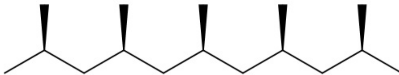
Figura 2: Estrutura polimérica do PP.
