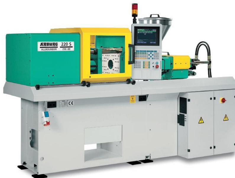
Figura 4.13 – Injetora Arbug Allrounder 220s usada na injeção.
