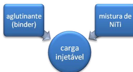
Figura 4.10 – Preparação da carga injetável.
