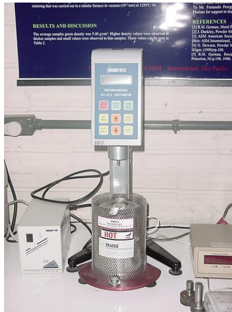
Figura 4.9 – Viscosímetro digital programável Brookfield DV-II+ usado para analisar o comportamento reológico das cargas.
