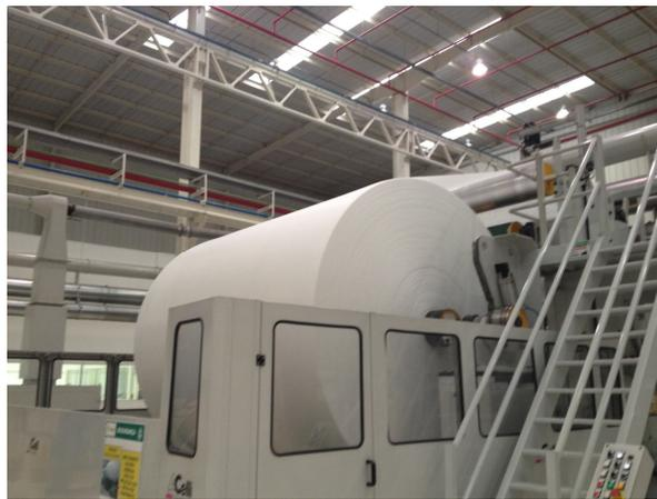
Figura 4.3: Rolo jumbo posicionado para iniciar o corte.
