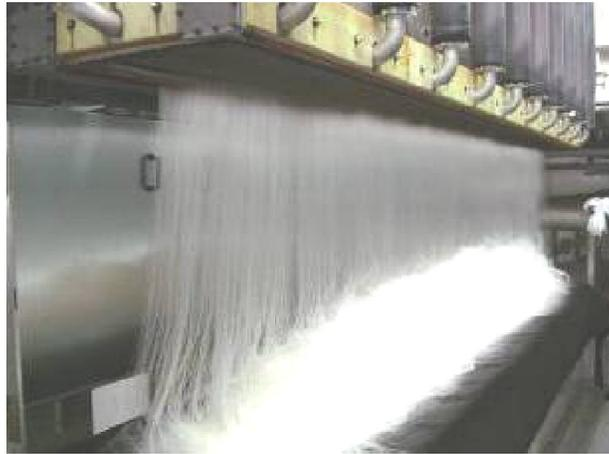
Figura 4.5: Filamentos de polipropileno sendo extrudados.
