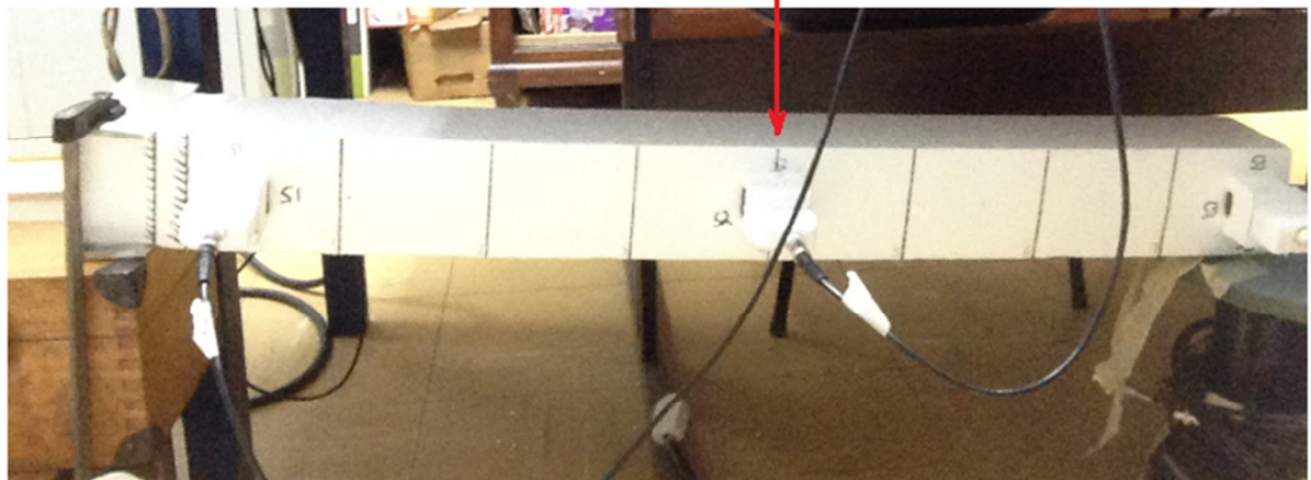
Figura 4.16 – (a) viga bi-apoiada ensaio ruptura, (b) esforço aplicado
