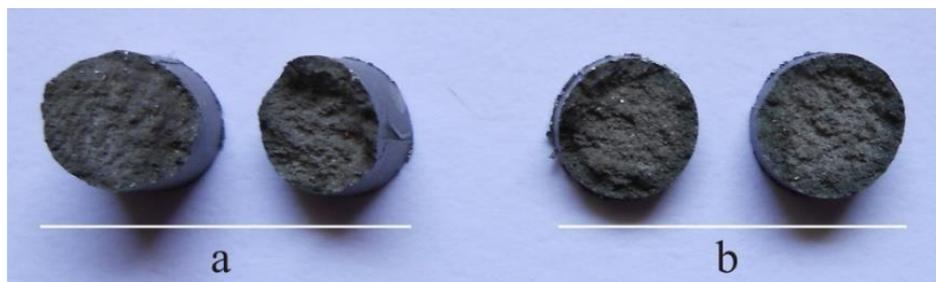
Figura 40 - Fraturas dos corpos de prova tracionados com velocidade de deformação (a) 1 mm/min; (b) 10 mm/min
