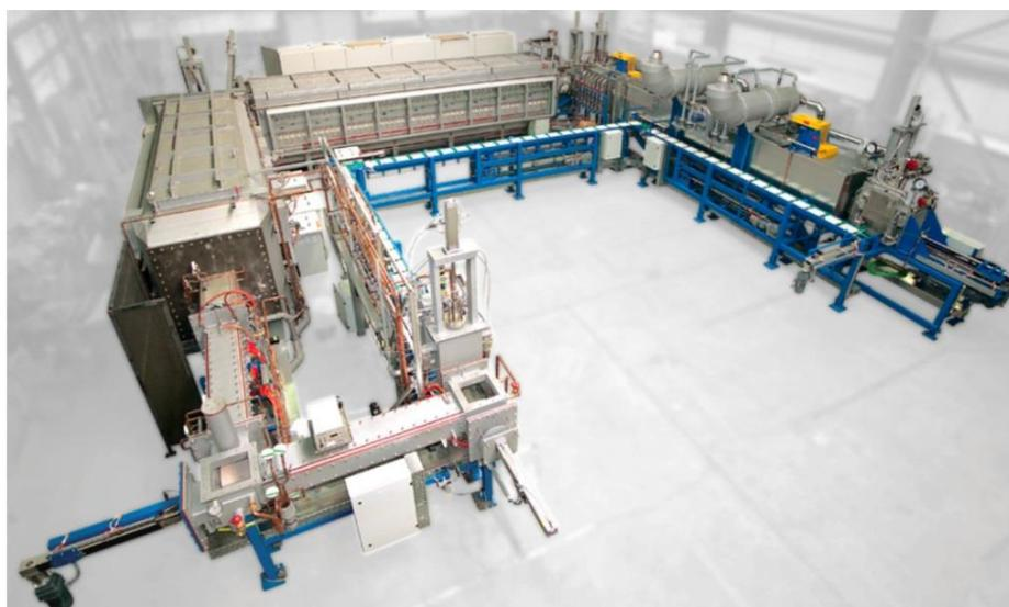
Figura 36 - Forno contínuo (extração do sistema aglutinante e sinterização) da marca Elino<sup>®</sup> [83].
