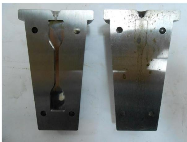
Figura 43-Molde cônico com cavidade ISO 527-2 para ensaios mecânicos de termoplásticos.
