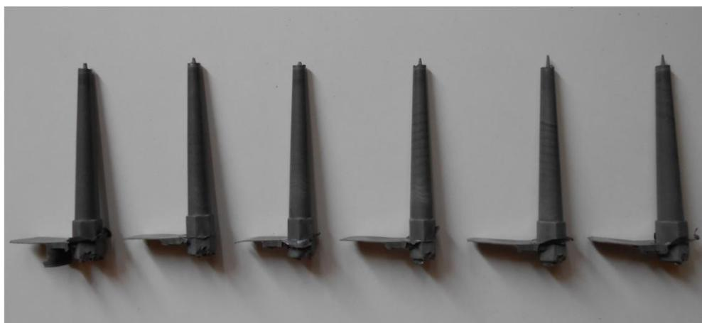
Figura 76 - Corpos de prova de paredes finas injetados
