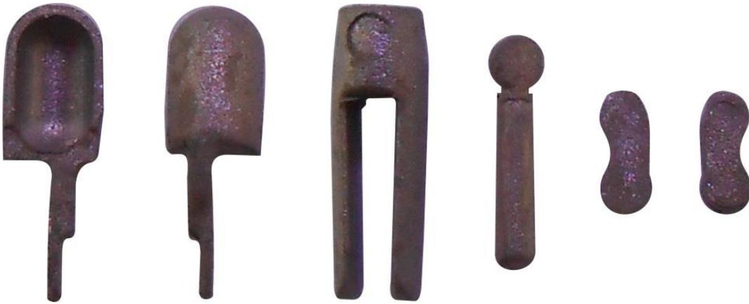
Figura 87 - Componentes da pinça sinterizados
