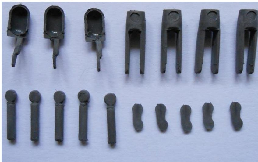
Figura 86 - Componentes da pinça microinjetados com CATAMOLD 316L A
