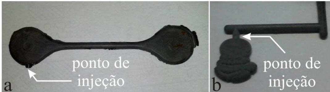
Figura 47 - Corpos de prova injetados: (a) CATAMOLD 8620; (b) CATAMOLD 316 L A.
