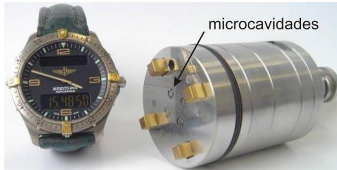
Figura 26 - Molde fabricado através de microusinagem [71]
