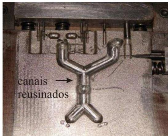
Figura 23 - Canal de injeção reusinado para  $\varnothing 6$  mm[9].
