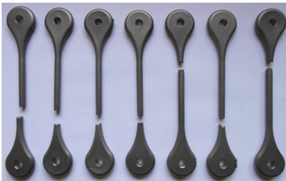
Figura 39 - Corpos de prova utilizados no ensaio de tração
