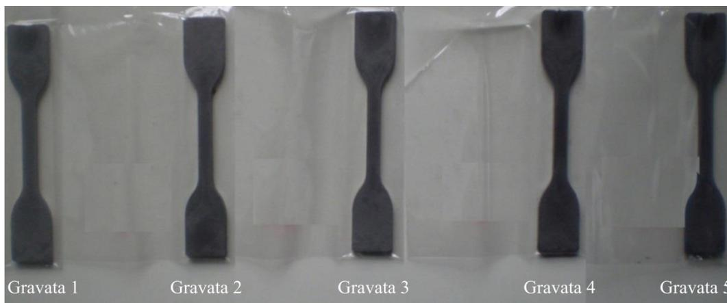
Figura 44 - Corpos de prova tipo gravata utilizados na determinação da quantidade de pó e sistema aglutinante da matéria prima.
