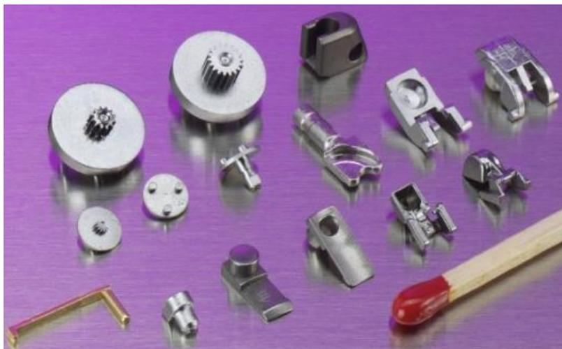
Figura 6 - Exemplos de produtos fabricados através do processo  $\mu$ *MIM* [26].
