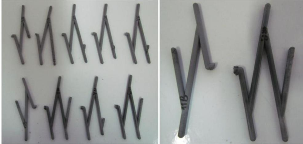
Figura 60 - Corpos de prova zig-zag injetados com CATAMOLD 316L A
