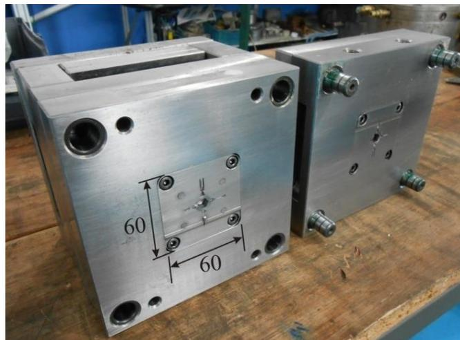
Figura 83 - Molde de injeção dos componentes da pinça.
