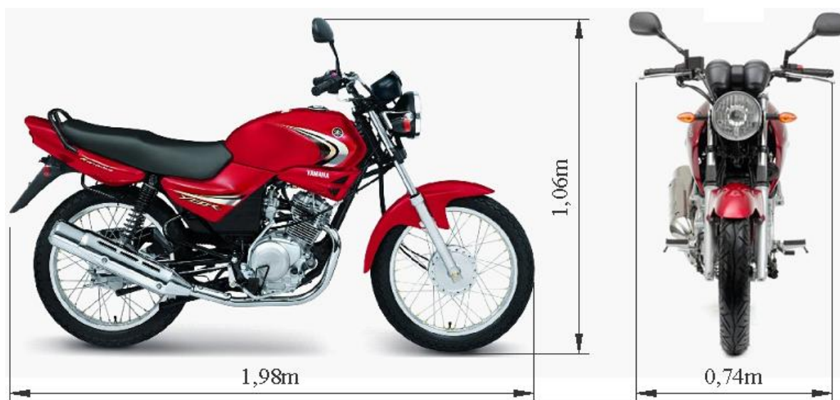
Figura 14: Dimensões de um veículo motorizado de duas rodas de padrão popular
