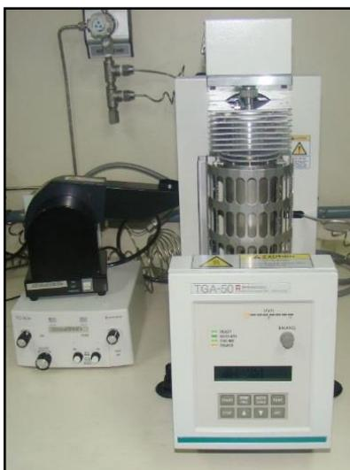
**Figura 18:** Equipamento para análise de TGA.
