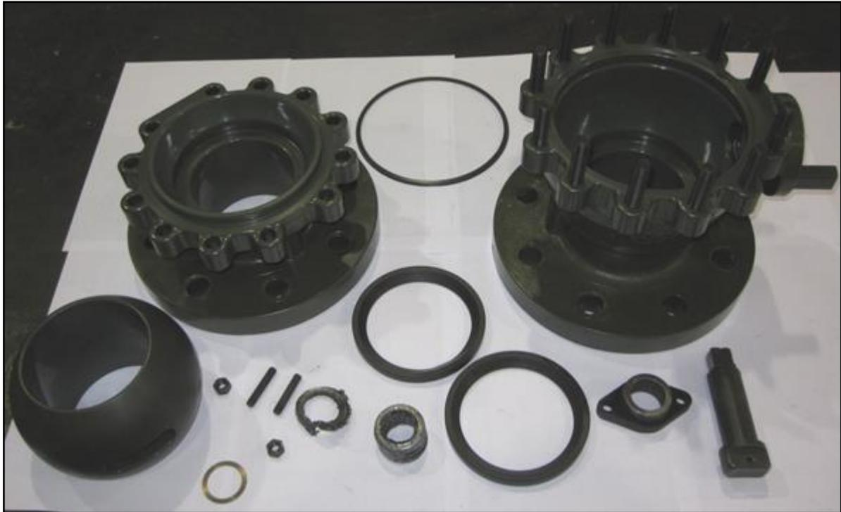
**Figura 55:** Componentes revestidos após os 1000 ciclos.
