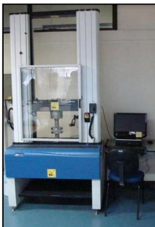
**Figura 16:** Máquina universal de ensaios utilizada para realização do ensaio de tração.
