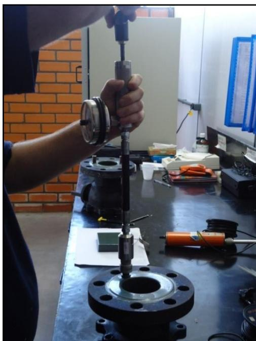
**Figura 29:** Ensaio de determinação de aderência (*Pull-off*) hidráulico.
