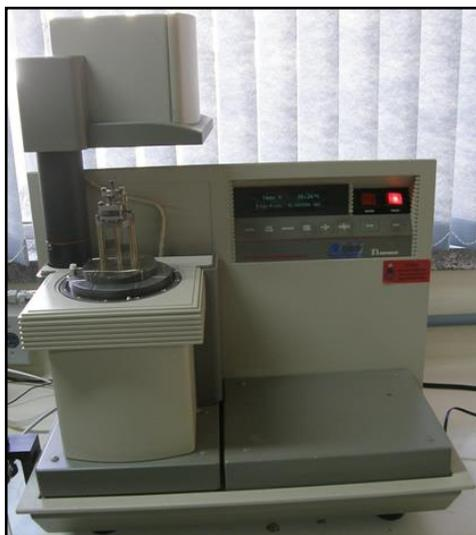
**Figura 19:** Equipamento para análise de DMA.
