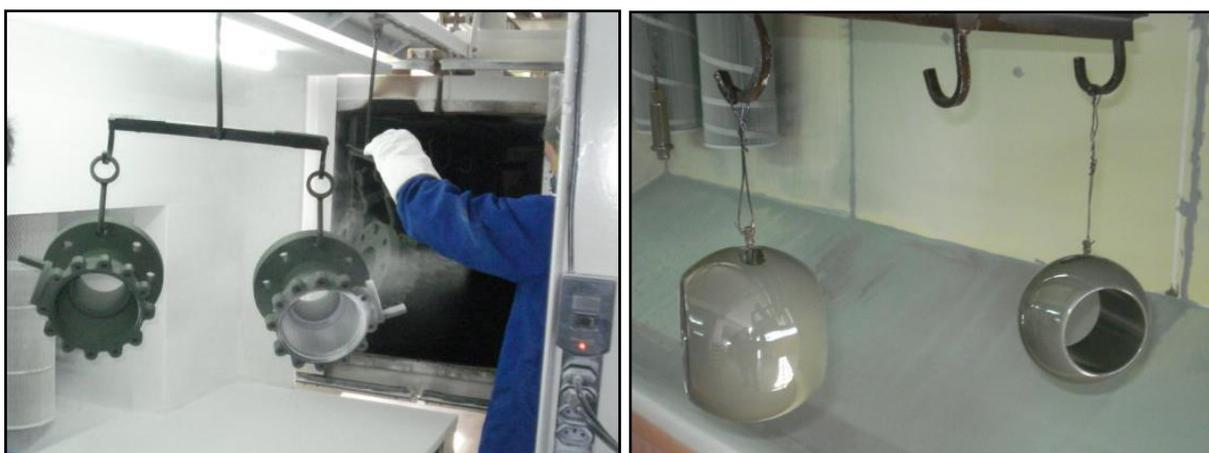
**Figura 24:** Aplicação do polímero nas peças aquecidas através de pistola eletrostática.
