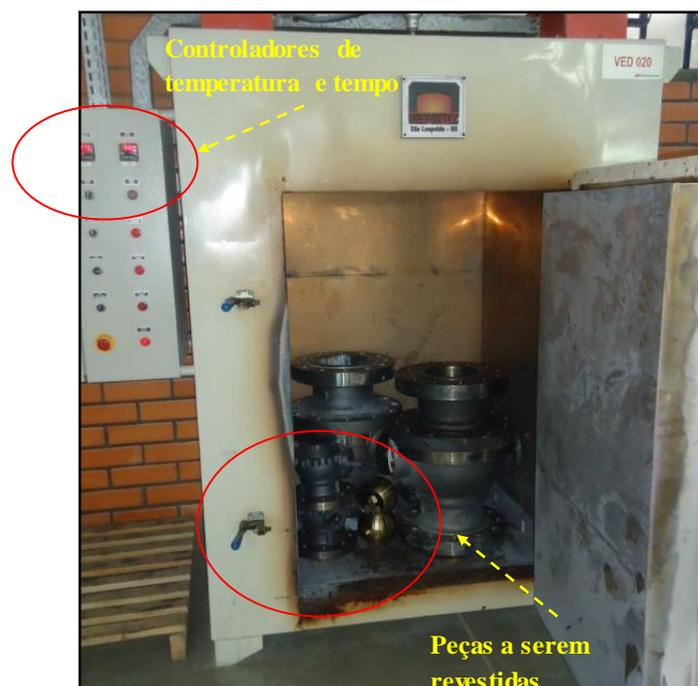
**Figura 21:** Processo de descontaminação térmica aplicada aos protótipos em forno (temperatura entre 350 - 400°C por 2 h).
