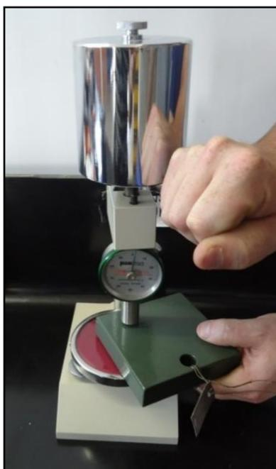
**Figura 34:** Medição de dureza do revestimento.
