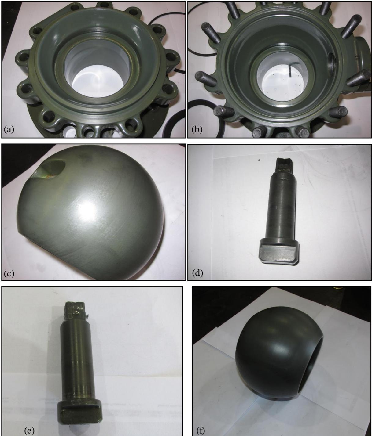
**Figura 56:** Detalhe dos componentes das válvulas: Protótipo 1: a) Corpo, b) Tampa, c) Haste, d) Esfera; Protótipo 2: e) Haste, b) Esfera.
