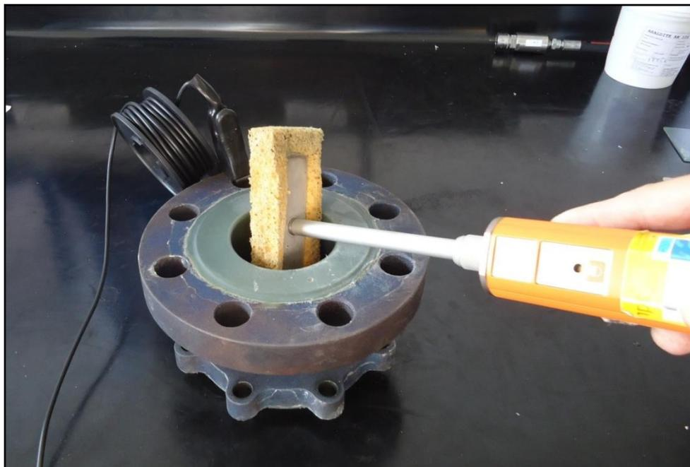
**Figura 33:** Ensaio de descontinuidade no revestimento (método *Holiday Detector* via úmida).
