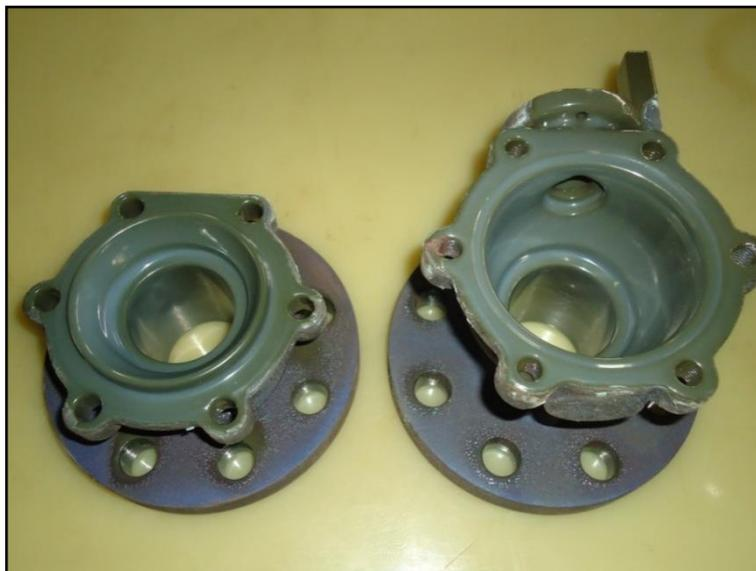
**Figura 46:** Visual do corpo e tampa da válvula.
