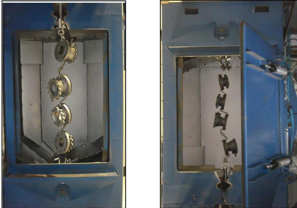
**Figura 22:** Equipamento de realização do processo de jateamento abrasivo das peças com a utilização de granalha de aço.
