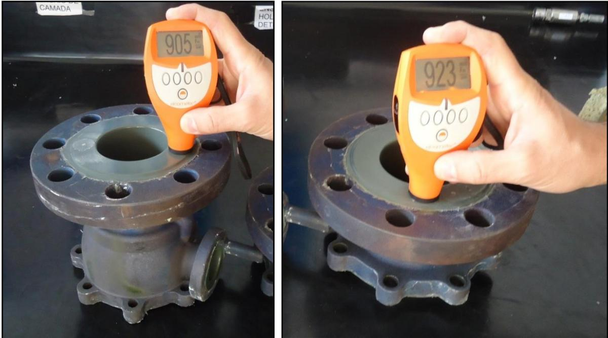
**Figura 32:** Demonstração de ponto de medição de espessura de película seca.
