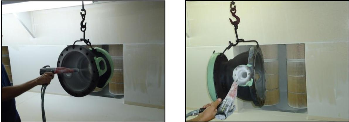
**Figura 15:** Componentes de válvulas sendo revestidos com utilização de pistola eletrostática.
