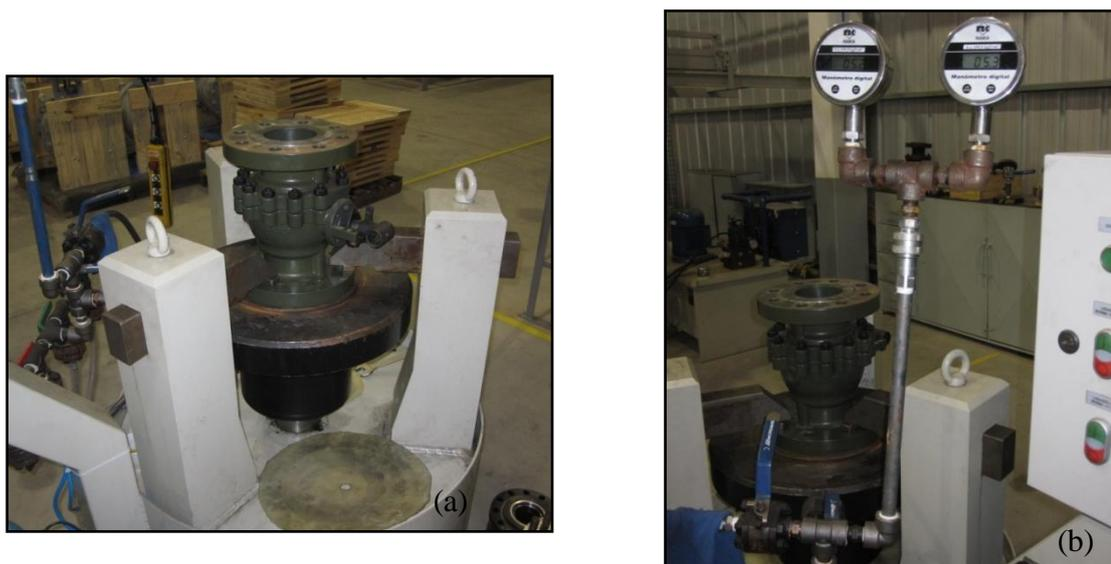
**Figura 38:** Bancada de testes de pressão: a) Fixação da válvula na bancada, b) Monitoramento da pressão hidrostática e pneumática.
