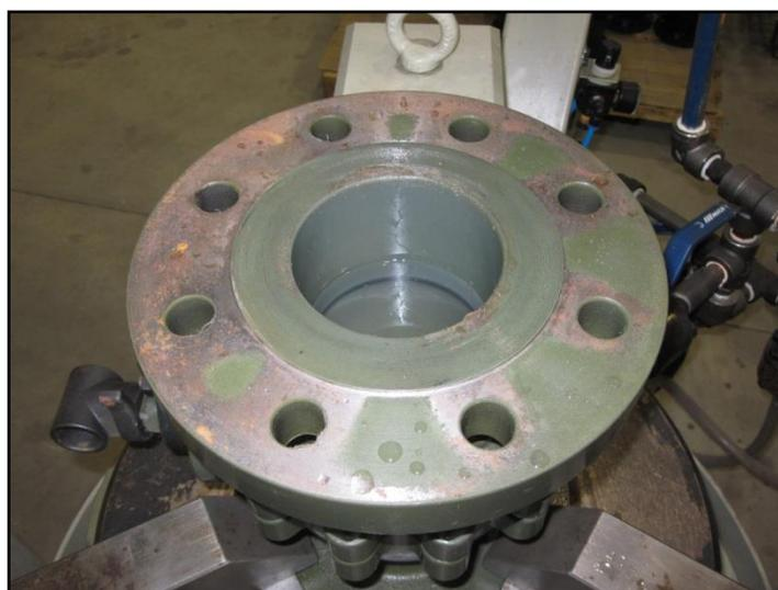
**Figura 47:** Demonstração de ausência de vazamentos visíveis em ensaios de válvulas.
