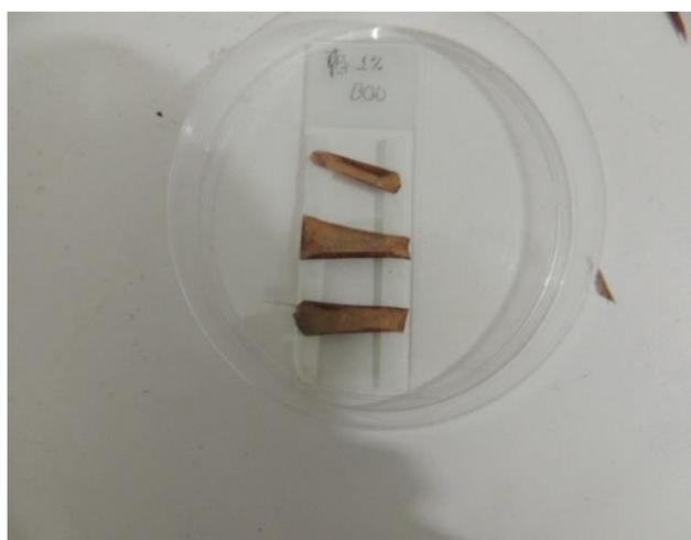
FIGURA 10. Placa de Petri contendo lâmina histológica de vidro com amostras de epicarpo de maçãs cv, Fuji fixadas com fita dupla face para secagem em dessecador. Laboratório de Pós-Colheita. UFRGS, Porto Alegre, 2012.
