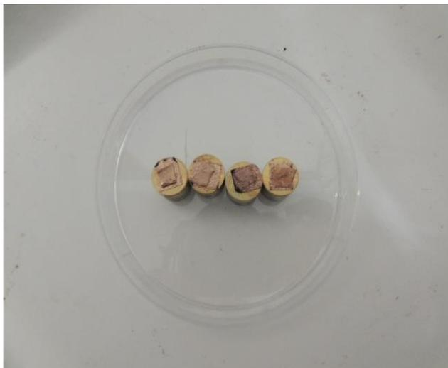
FIGURA 11. Suportes de alumínio (*stub*) com fragmentos de 1mm<sup>2</sup> de epicarpo de maçãs cv. Fuji para metalização (recobrimento por camada de 15nm de ouro). Laboratório de Pós-Colheita. UFRGS. Porto Alegre, 2012.
