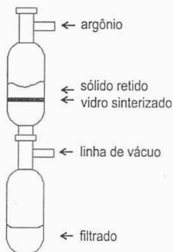
Figura 5.2: Sistema de filtração empregado nas preparações.
