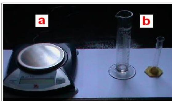
Figura 10. Instrumentos para medição de massa (a) e volume (b) utilizados.
