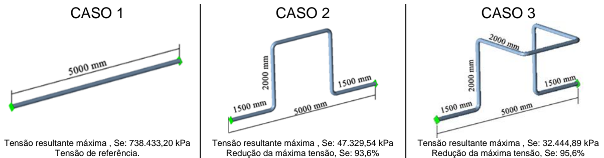
Figura 6.3 - Redução da tensão resultante com a adição "U" em relação a um tubo reto.
