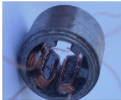
Figura 51 - Mini motor preliminar com bobinamento
