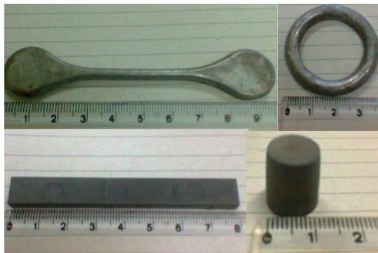
Figura 44 - Geometrias dos Corpos de provas injetados
