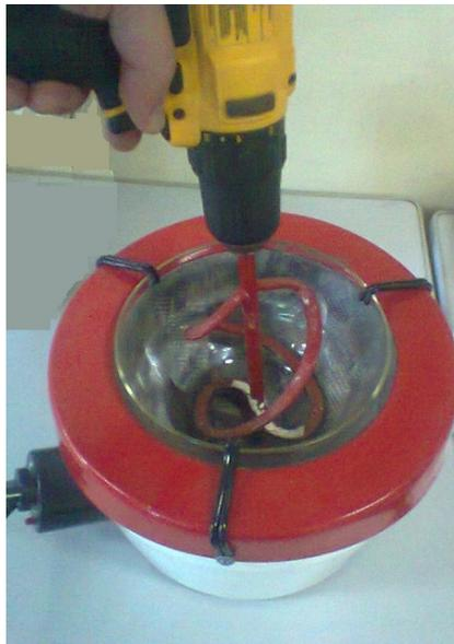
Figura 64 - Sistema manual desenvolvido para mistura de cargas injetáveis
