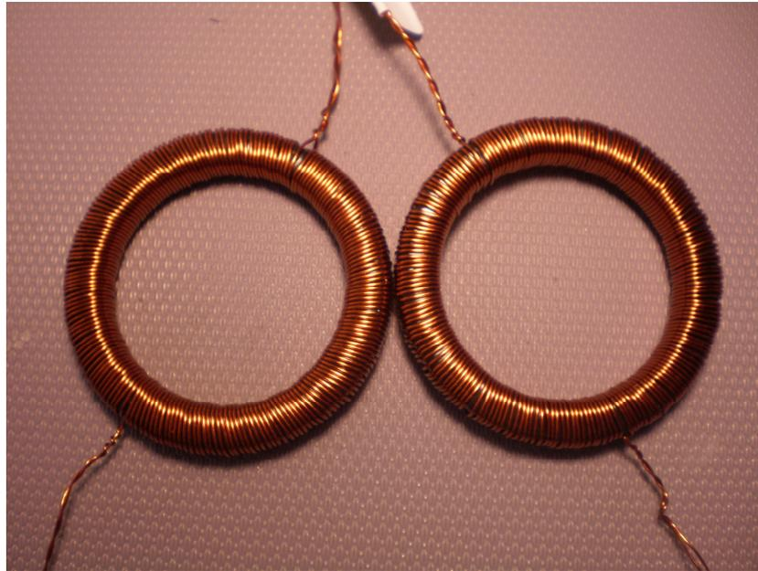
Figura 32 – Anéis de Rowland prontos para ensaios magnéticos
