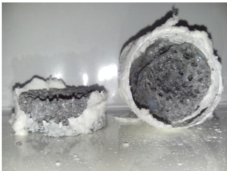
Figura 5.1 - Meio poroso de carbetto de silício degradado termicamente.
