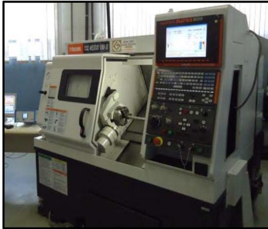
Figura 4.1: Torno CNC Mazak QTN 100-II.
