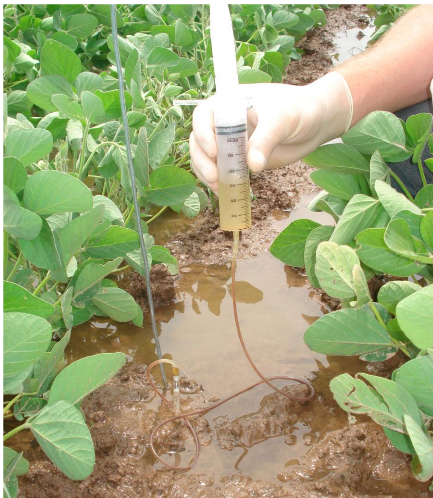
FIGURA 1. Coleta da solução do solo realizada nas unidades experimentais durante o período de inundação. Cachoeirinha, RS, 2012/13.
