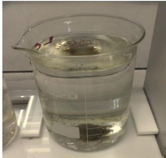
Figura 4.7: Flocos após adição de 30 mg/L de Tanfloc SG
