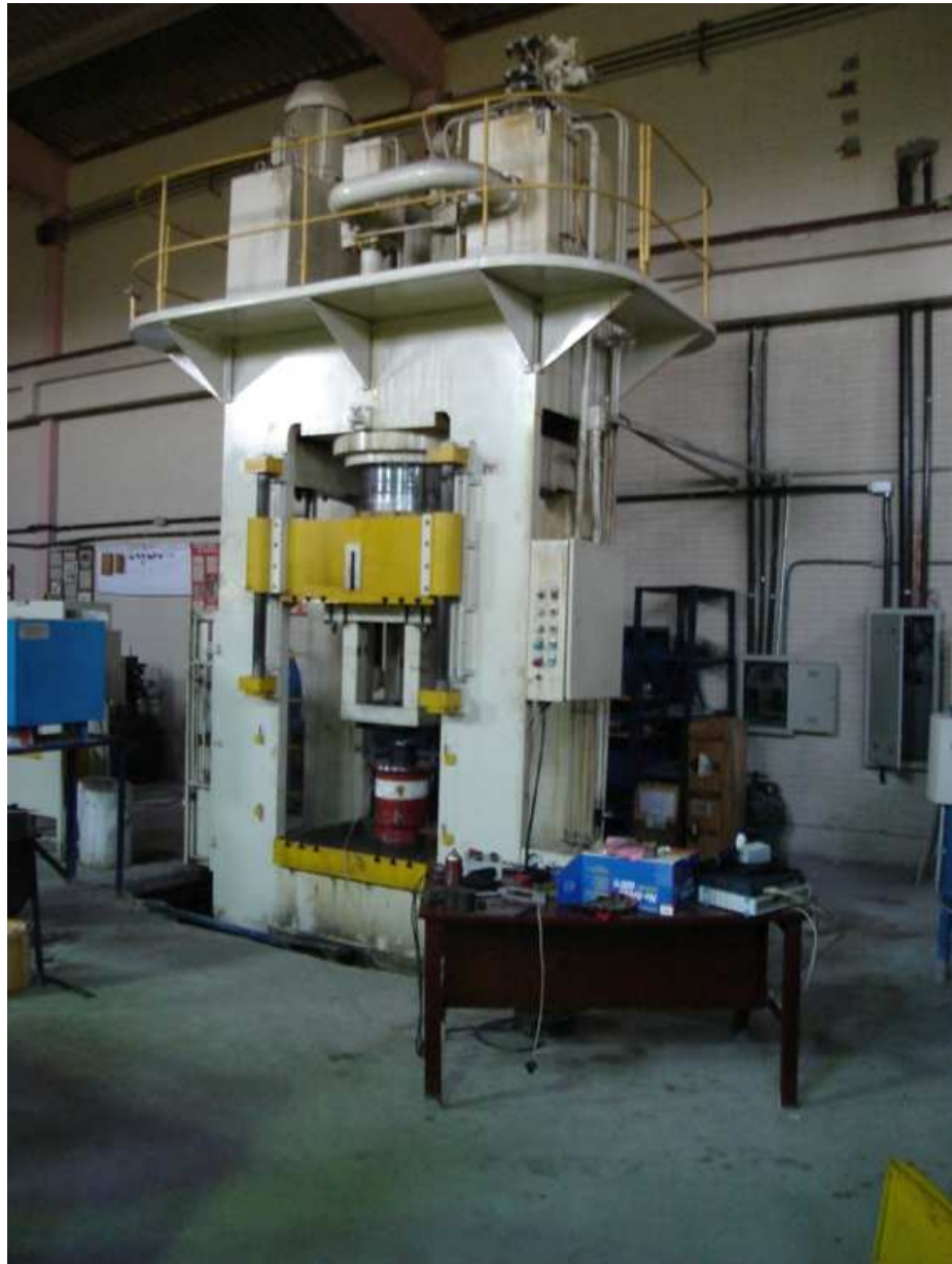
Figura 5.7 – Prensa hidráulica de 7350 kN utilizada no LdTM para forjamento da pré-forma.
