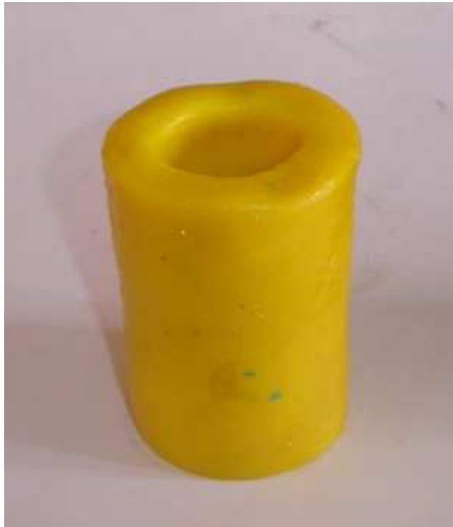
Figura 4.11 - Peça de plasticina forjada com altura inicial de 56mm não mostrando formação de rebarba com volume de 63845mm 3 .
