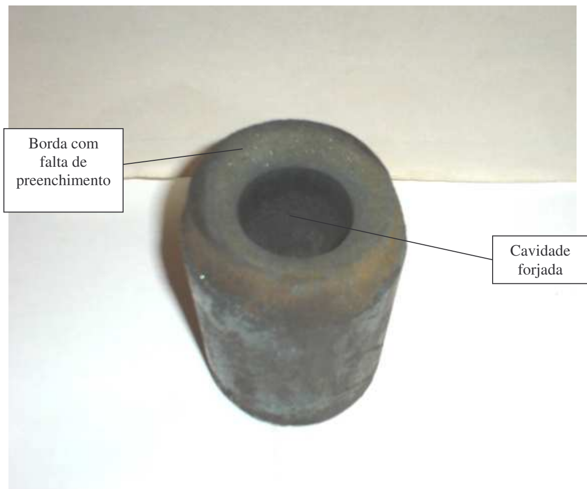
Figura 5.14 – Peça forjada com falta de preenchimento na borda superior.
