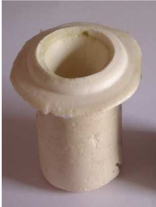
Figura 4.10 – Peça de plasticina forjada com altura inicial de 60mm, diâmetro de 38,1mm, mostrando a formação de rebarba com volume de 68405mm 3 .
