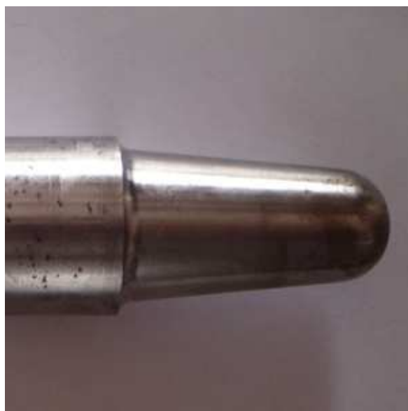
Figura 4.7 – Vista do punção cônico de penetração com angulação necessária para o forjamento da cavidade.
