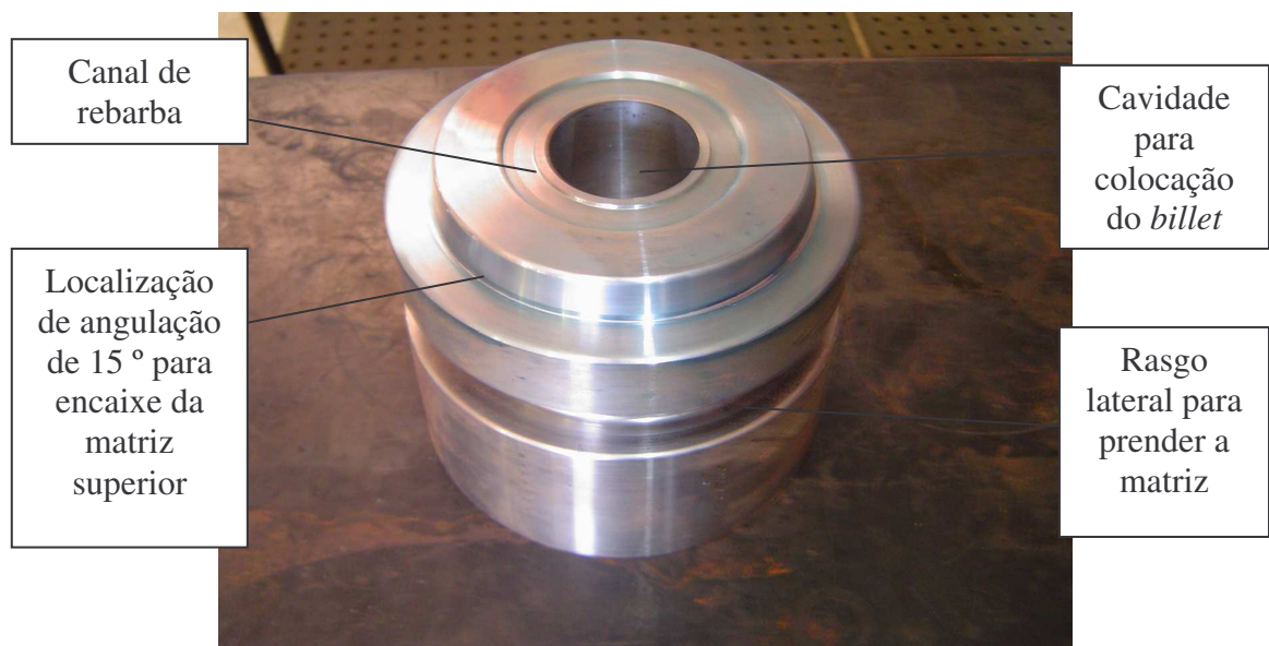
Figura 5.4 – Matriz inferior produzida em um CNC.
