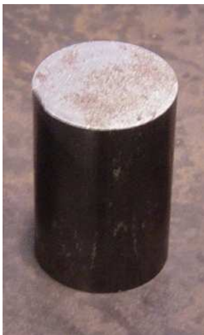
Figura 3.3 – Peça cilíndrica de aço AISI 8640 para início do processo de usinagem com altura de 62mm, diâmetro de 38,1mm e volume de 70685mm 3 .
