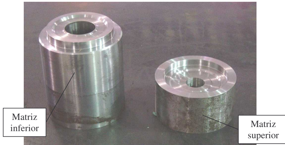
Figura 4.3 – Matriz inferior à esquerda e matriz superior à direita.
