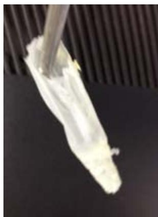
Figura 4.1: Ilustração de filme de P(3HB) resultante da extração com combinação clorofórmio e hipoclorito de sódio
