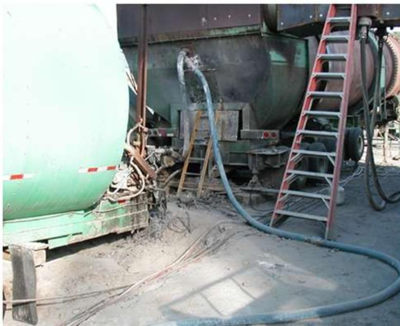
Figura 2.8 – Adaptação para introdução de Advera<sup>®</sup> WMA em usina de asfalto.
