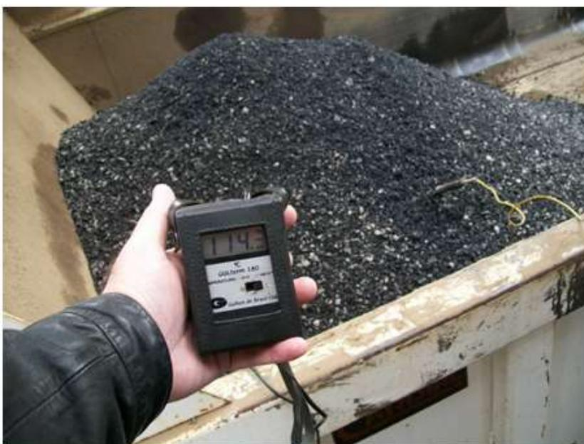
Figura 5.6 - Temperatura de produção da mistura morna na usina ( $114,3^{\circ}\text{C}$ )
