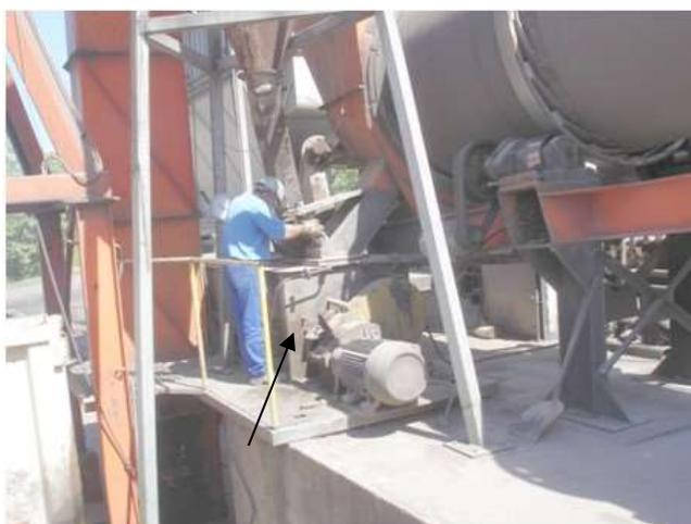
Figura 5.1 - Detalhe misturador e janela por onde foram introduzidas as zeólitas
