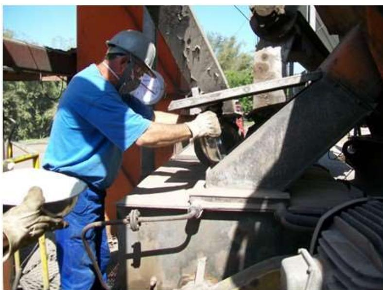
Figura 5.9 – Inserção da zeólita no misturador
