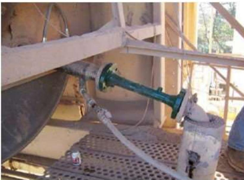
Figura 2.31 – Tubo injetor da mistura de água e CAP no misturador- Sistema Meeker – Acquafoam.
