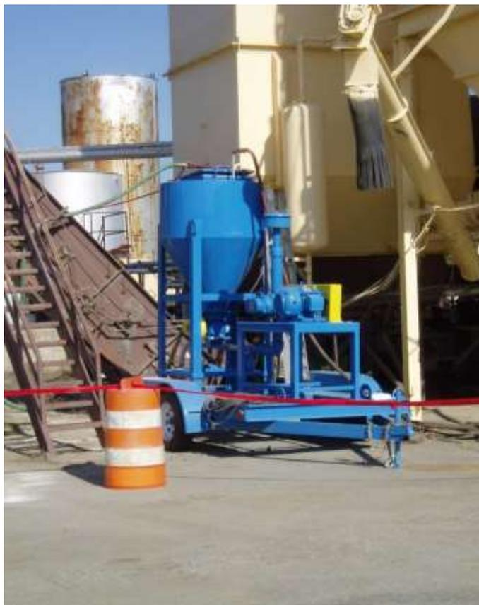
Figura 2.18 – Equipamento injetor de Aspha-min<sup>®</sup>
