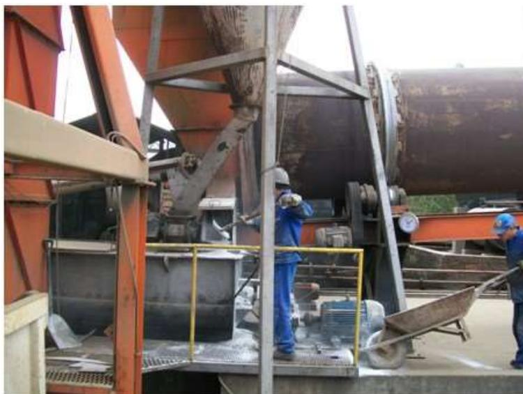
Figura 5.4 - Descarregamento da mistura zeólita + cal no misturador com controle do tempo
