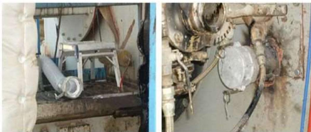
Figura 2.9 – Adaptação para introdução de Advera<sup>®</sup> WMA em usina de asfalto.
