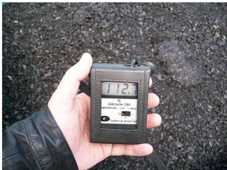
Figura 5.16 – Temperatura da mistura morna ao chegar no LAPAV/UFRGS
