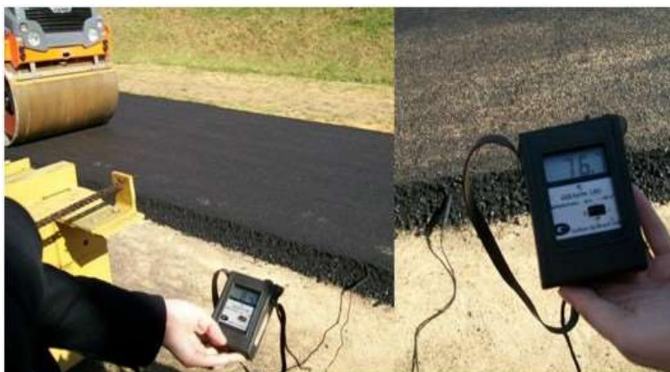
Figura 5.23 - Início e final da compactação da mistura morna com rolo de chapa (84,6°C e 76,7°C)
