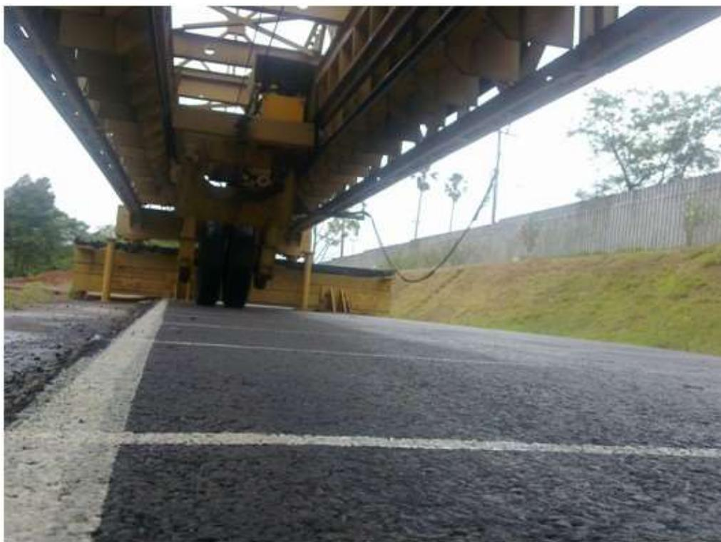
Figura 6.15 – Pista 1, aparência final da pavimento após N de 103471 ciclos.
