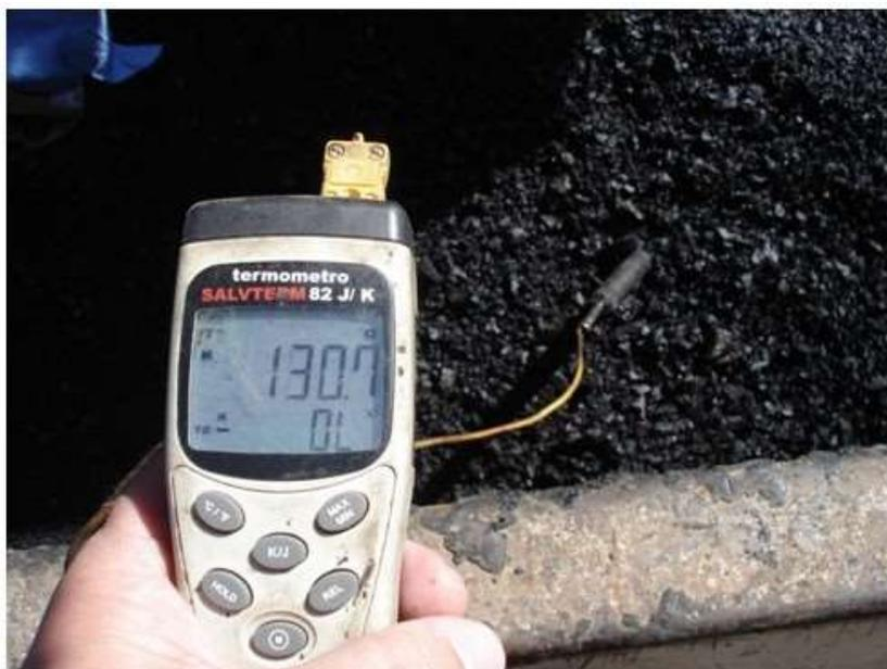
Figura 5.11 – Controle da temperatura da massa morna com termômetro tipo espeto
