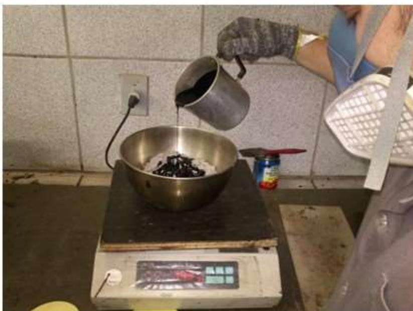
Figura 3.20 - Adição de CAP e zeólitas naturais aos agregados para a fabricação da mistura morna
