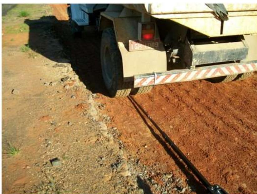
Figura 5.27 - Pista 2 – Verificação do subleito argiloso com viga benkelman
