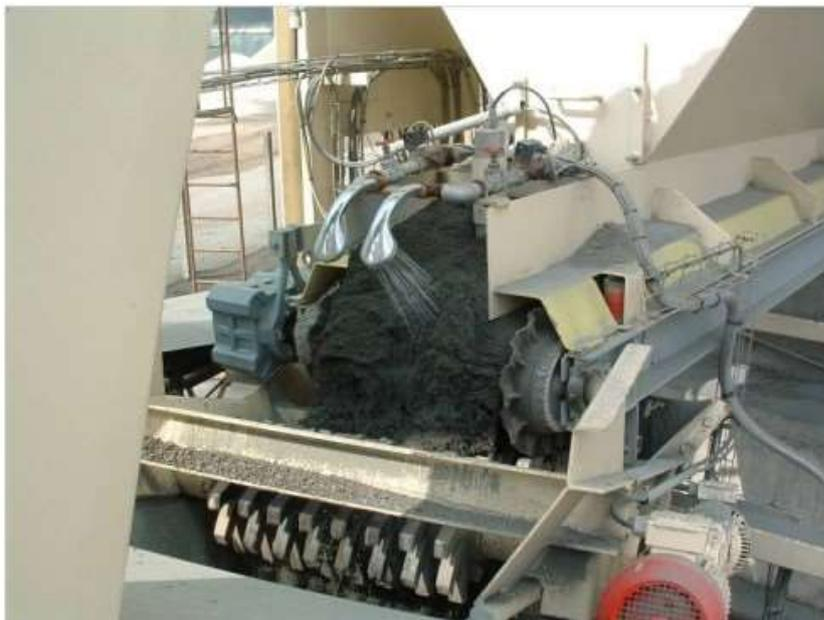
Figura 2.26 – Agregados miúdos molhados na temperatura ambiente no processo LEA
