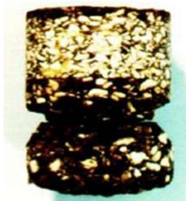
Figura 2.41–Falha de adesão na mistura asfáltica
