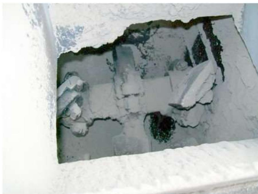
Figura 5.2 - Detalhe das pás no interior misturador em vista superior na janela por onde foram introduzidas as zeólitas
