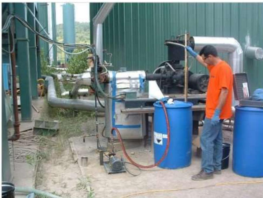
Figura 2.27 – Sistema de injeção de aditivo no processo LEA
