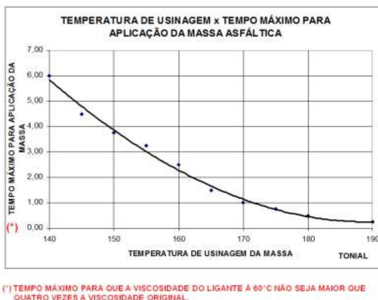
Figura 5.24—Gráfico temperatura de usinagem x tempo máximo para aplicação da massa asfáltica
