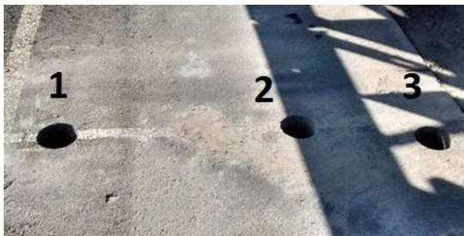
Figura 6.60 – Posição dos furos de onde foram extraídos os CPs para verificação da espessura da camada de revestimento
