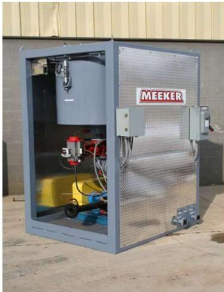
Figura 2.30 – Misturador de água e CAP do sistema Meeker – Acquafoam.
