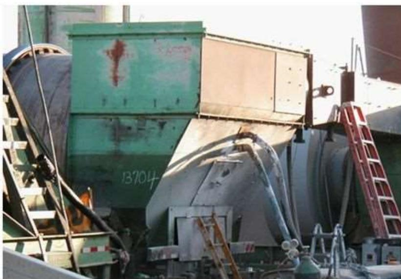
Figura 2.7 - Adaptação para introdução de Advera<sup>®</sup> WMA em usina de asfalto.
