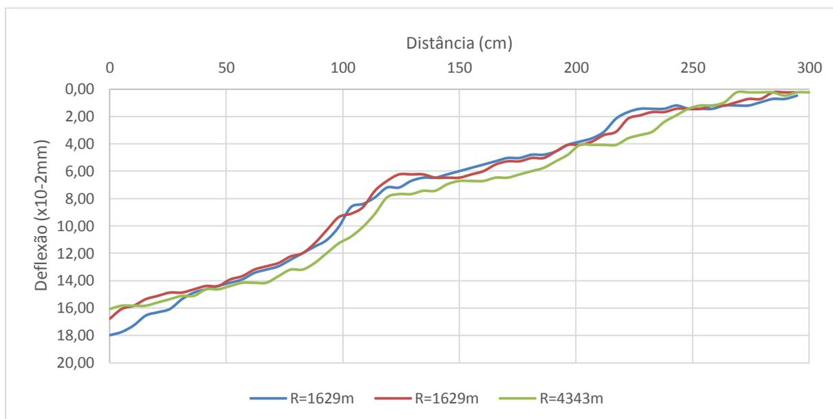
Figura 6.12 – Pista 1: Deflexão e raio de curvatura para N=88453 (Seção 5)
