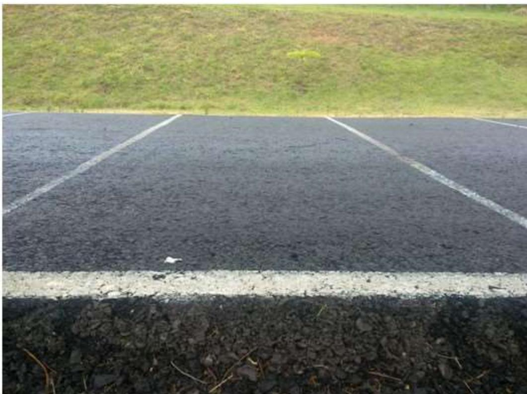
Figura 6.14 – Pista 1, aparência final da pavimento após N de 103471 ciclos.
