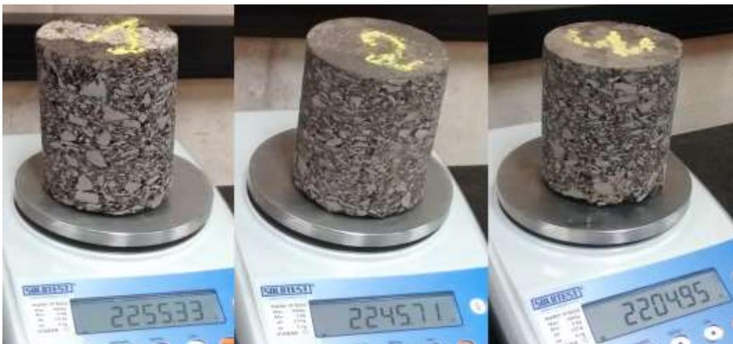
Figura 6.65 – Pesagem dos corpos de prova extraídos da pista 2D
