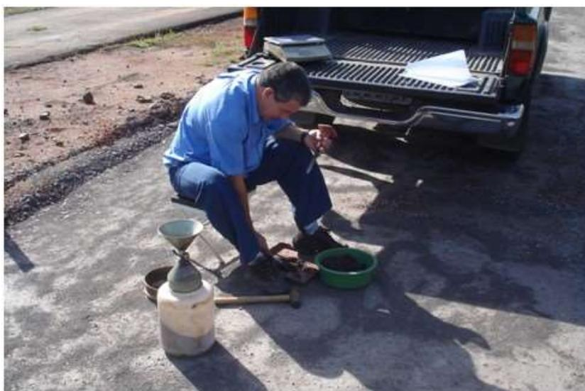
Figura 5.31 – Controle do grau de compactação base de brita graduada através do método do frasco de areia
