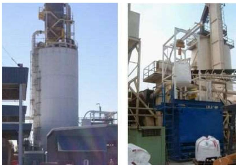
Figura 2.10 - Armazenagem em silo e em big-bags da zeólita sintética Advera<sup>®</sup> WMA
