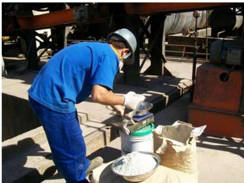
Figura 5.8 – Pesagem de 3kg de zeólitas naturais para inserção no misturador
