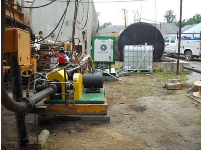
Figura 2.3 – Sistema Accu-Shear<sup>®</sup> montado em usina de asfalto
