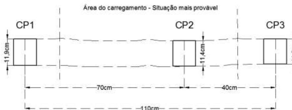
Figura 6.64 – Situação mais provável de ocorrência no revestimento asfáltico
