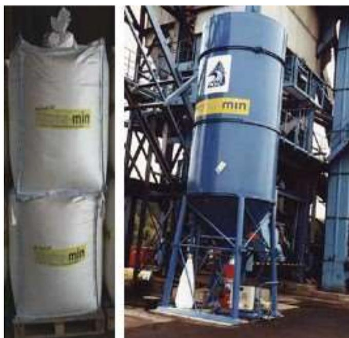
Figura 2.17 – Armazenamento de Aspha-min<sup>®</sup> em big-bags e silo
