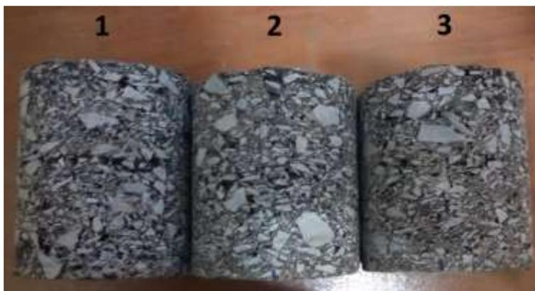
Figura 6.61 – Corpos de prova extraídos da Pista 2 - LD
