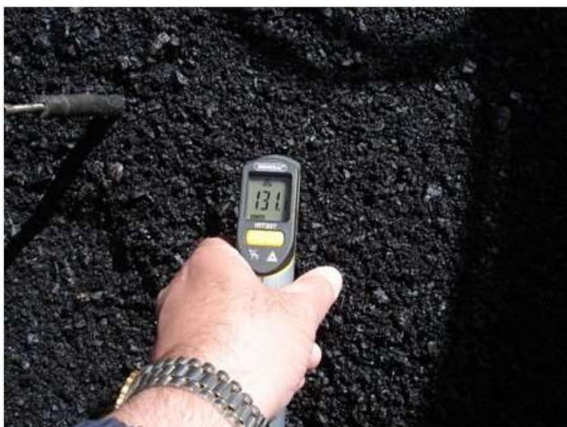
Figura 5.12 – Controle da temperatura da massa morna com termômetro tipo pistola a laser
