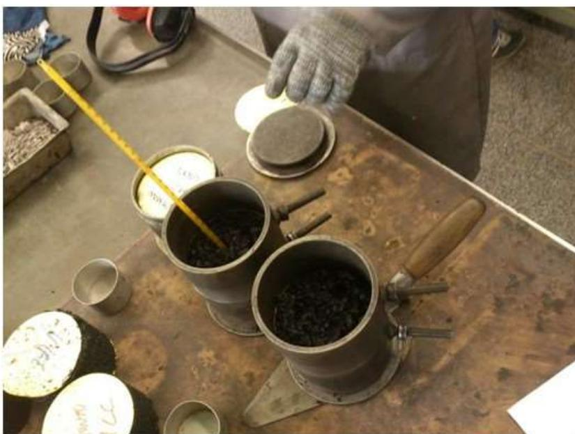
Figura 3.22 - Mistura morna aguardando temperatura de compactação dentro de molde de corpos-de-prova
