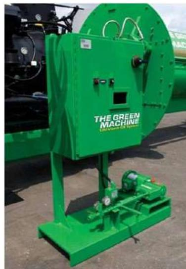
Figura 2.36 – Controlador da entrada de água e CAP Gencor – Ultrafoam GX2
