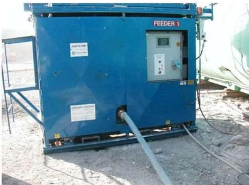
Figura 2.6 – Adaptação para introdução de Advera<sup>®</sup> WMA em usina de asfalto.
