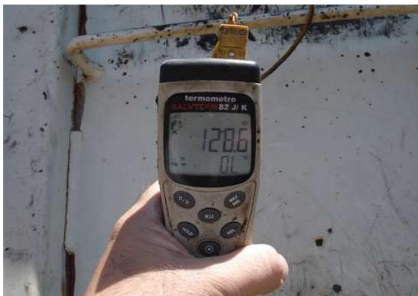
Figura 5.34 – Medida de temperatura na caçamba na chegada ao LAPAV
