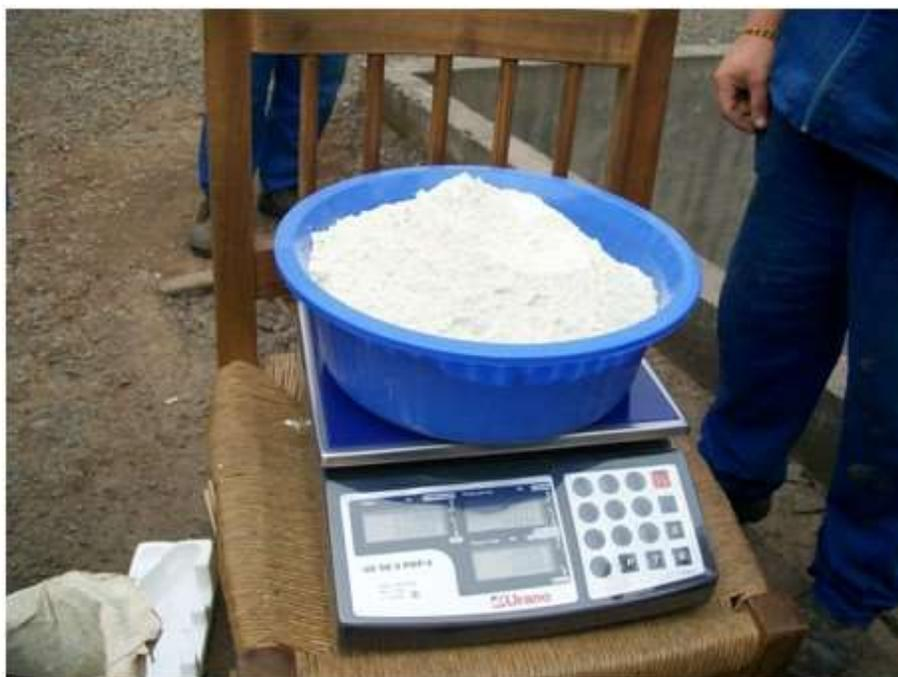
Figura 5.3 - Pesagem de zeólita para mistura com cal antes da adição no misturador
