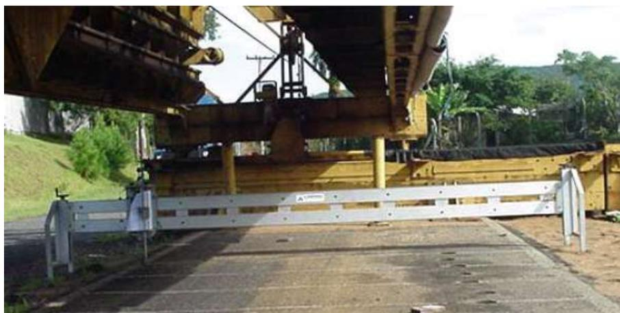
Figura 3.25–Aplicação do perfilógrafo na seção transversal
