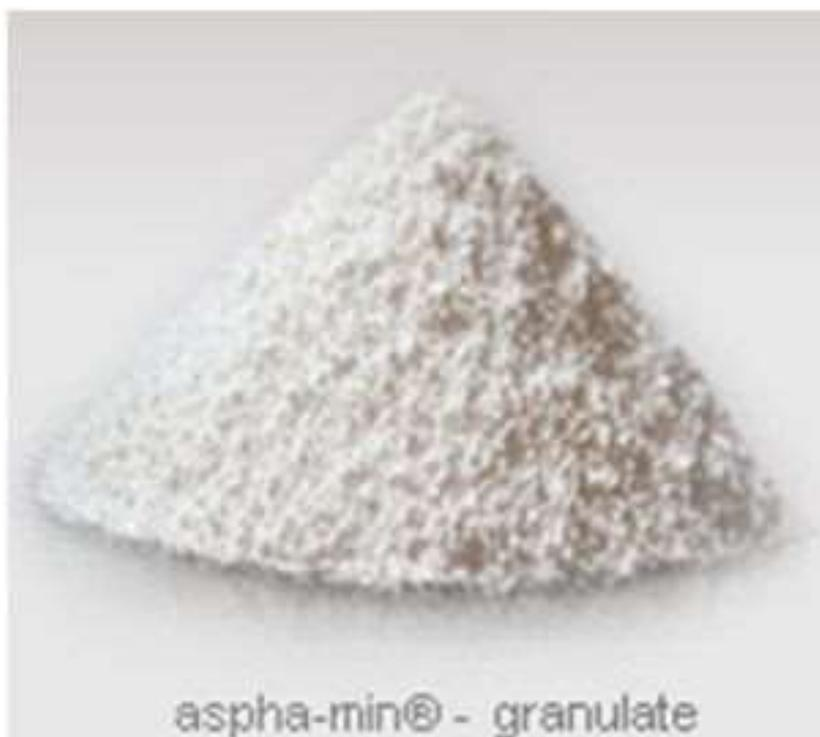
Figura 2.16 – Aparência da zeólita sintética Aspha-min<sup>®</sup>
