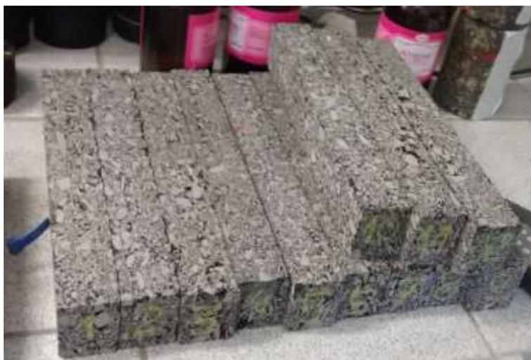
Figura 4.20 – Vigotas produzidas para o ensaio de fadiga
