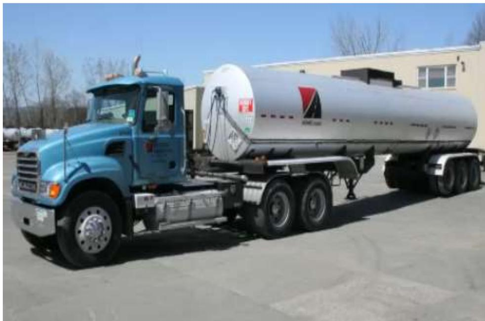
Figura 2.45 – Caminhão tanque para transporte de SonneWarmix™.
