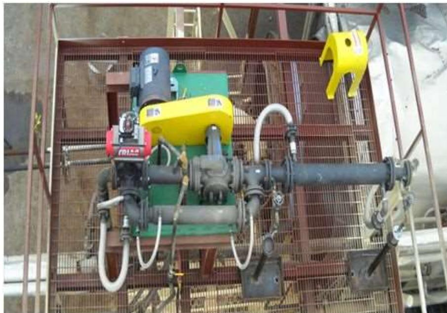
Figura 2.2 – Equipamento para mistura pressurizada do sistema Accu-Shear<sup>®</sup>
