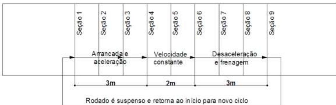
Figura 6.59 – Ciclo do simulador de tráfego do LAPAV/UFRGS
