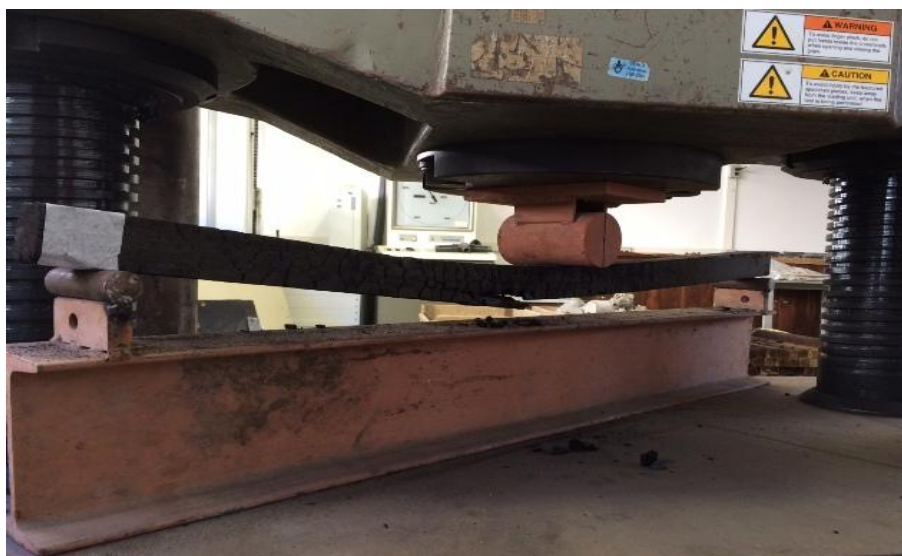
Figura 11 – Ensaio de resistência à flexão
