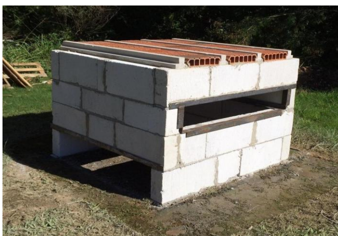
Figura 3 – Simulador de incêndio utilizado durante a pesquisa
