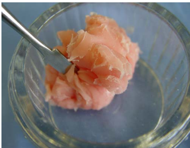
Figura 8. Fase plástica da mistura pó/líquido
