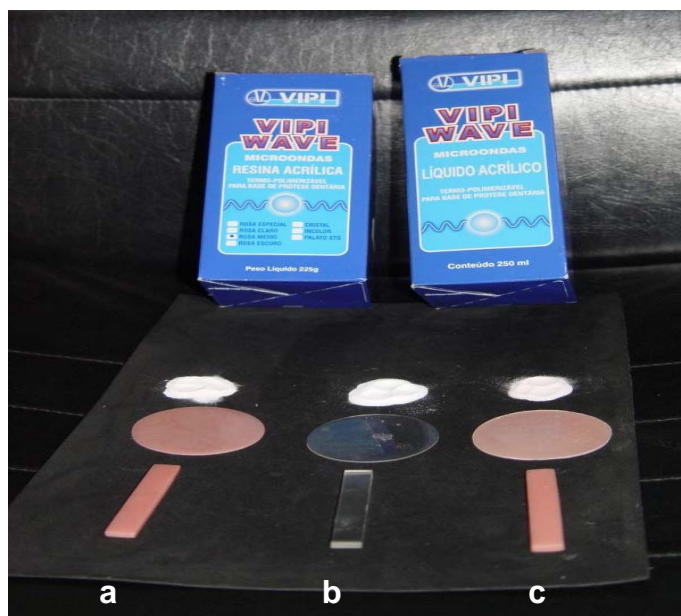
Figura 39. Resina rosa com fibras (a), resina Incolor (b) e resina rosa sem fibras (c)
