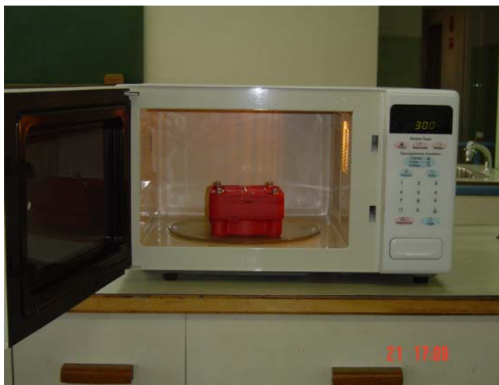
Figura 10. Mufla no forno de microondas para polimerização
