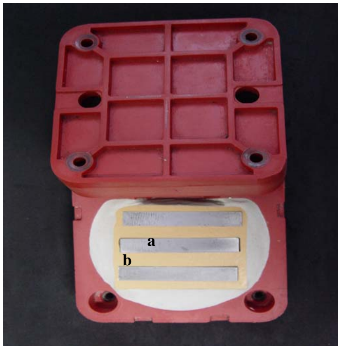
Figura 13. Matriz de aço (a) incluída na matriz de silicone (b)
