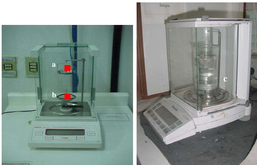
Figura 22. Balança usada no ensaio de determinação da massa específica a - Posição do cp suspenso no ar b - Posição do cp dentro do recipiente que é imerso no líquido c – Béquer com o líquido dentro do qual o cp é imerso.
