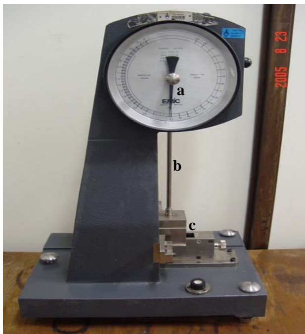
Figura 19. Máquina EMIC – A 1 C para Resistência ao Impacto Izod a - ponteiro de arrasto b - pêndulo c - martelo com 2,7 J
