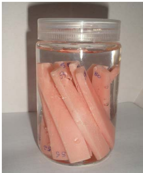
Figura 46. Corpos de prova imersos em água deionizada e armazenados em estufa
