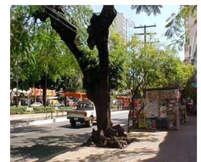
Figura 171. inadequação de espécie arbórea (flamboaiã) com a calçada e rede elétrica.
