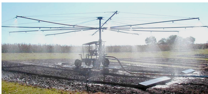
FIGURA 1. Aparelho simulador de chuva de braços rotativos utilizado na pesquisa, operando sobre um par de parcelas experimentais de erosão.
