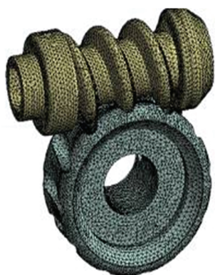
Figure 1. Worm gear meshed model. Source: A. L. Gasparin, L. L. Corso, E. K. Tentardini, R. C. R. Nunes, M. M. C. Forte, R. V. B. Oliveira.
