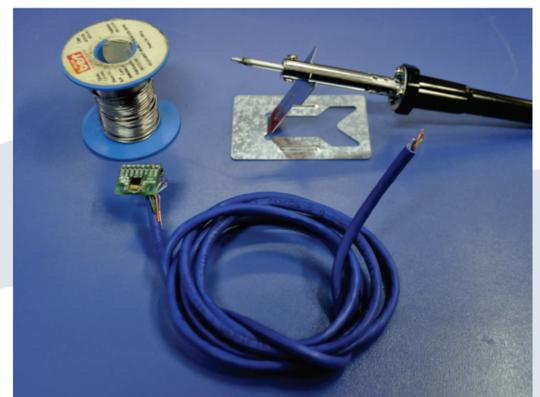
Materiais utilizados para a soldagem dos acelerômetros
