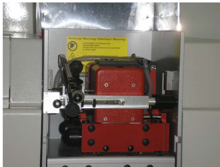
Figura 3. Sistema de introdução de amostras sólidas. (a) 1 – módulo principal fixado no compartimento do forno de grafite, 2 – pinça metálica conectada no módulo principal, 3 – plataforma de grafite e (b) sistema instalado. 47
