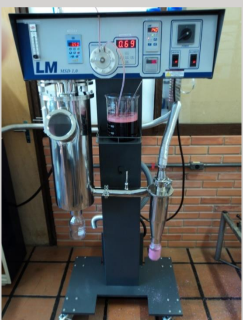
Figura 2- Mini Spray Dryer (LM MSDi 1.0, LABMAQ, Brasil)
