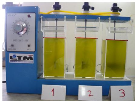
Floculantes 3min a 120rpm + 5, 10 e 15min a 15rpm
