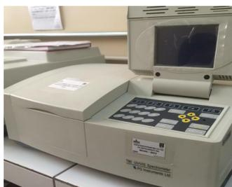
Absorbância Espectrofotômetro UV-VIS PG T80 720 nm
