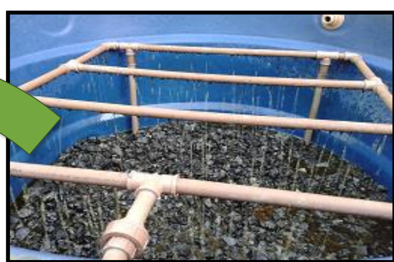
Figura 1. Lixiviação do concentrado de pirita em planta piloto.
