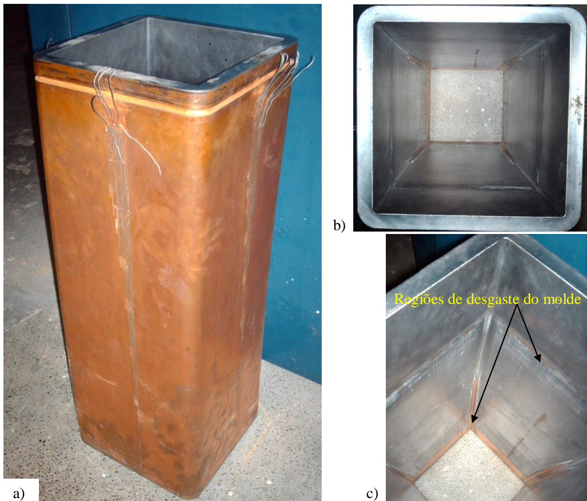
Figura 6.2 Fotos do molde de seção 240x240mm parabólico após seu uso, mostrando a) termopares inseridos no molde e; b) cavidade interna e c) detalhes nas regiões de desgaste da parede interna.
