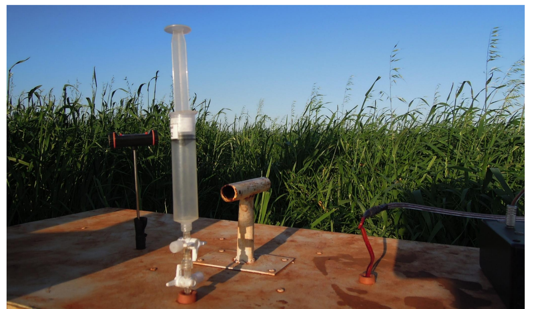
Figura 3. Câmaras estáticas com seringa para amostragem.
