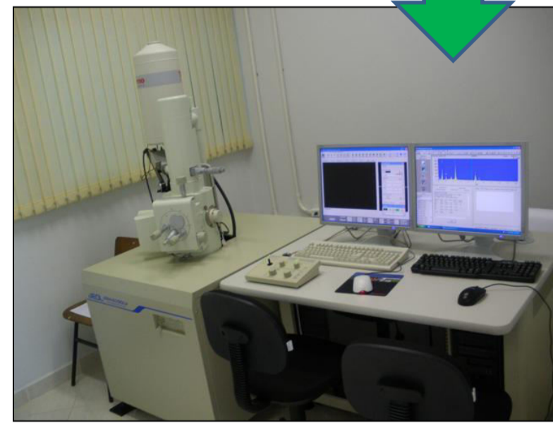
Fig.7: Microscópio Eletrônico de Varredura utilizado para imageamento dos zircões.
