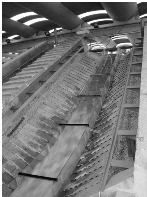
Figura 3.4 – Modelo experimental construído no Laboratório Nacional de Engenharia Civil (LNEC) no âmbito do programa de investigação para o “Estudo detalhado sobre a construção de vertedouros de cheia em blocos pré-fabricados sobre barragens de aterro” promovido pelo Instituto Superior Técnico, LNEC e Instituto da Água (Portugal). Cortesia do Engenheiro A. T. Relvas e Professor A. N. Pinheiro.
