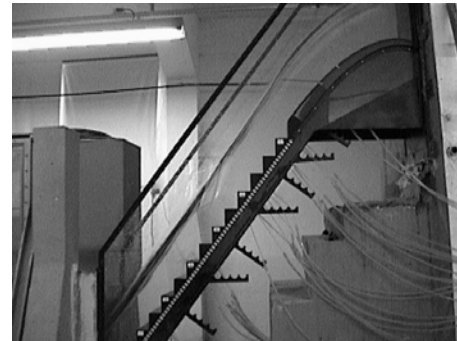
(f) Calha escalonada 1V:0,75H e h = 0,09 m
