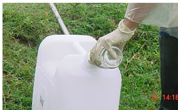
Figura 10 – Galão de polipropileno de 20 litros sendo utilizado para armazenar as amostras de sedimentos fluviais em suspensão.
