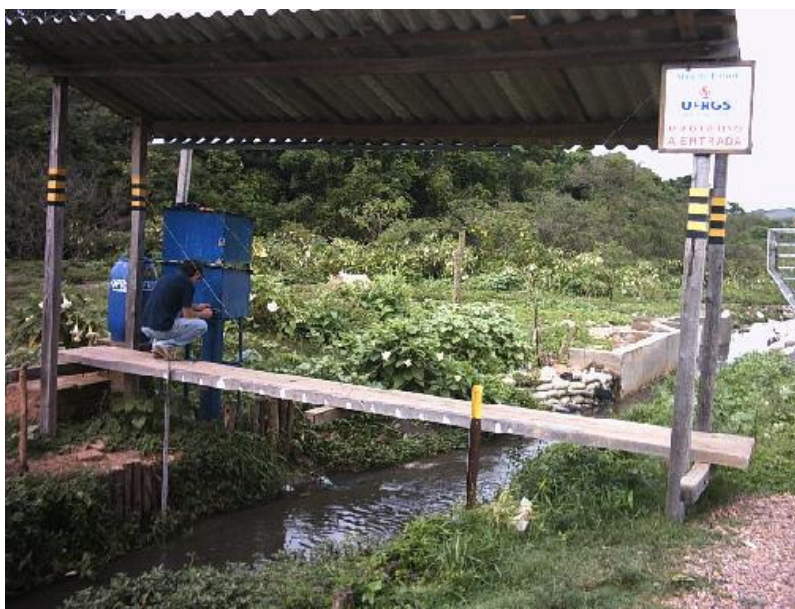
Figura 7 – Seção Hidrossedimentométrica instalada no exutório da bacia urbana e utilizada para as coletas de amostras de sedimentos fluviais em suspensão entre os anos de 2003 e 2006.
