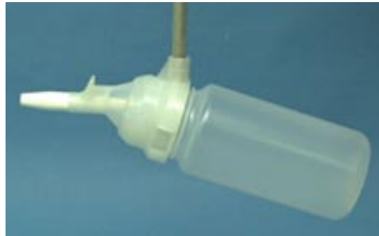
Figura 9 – Amostrador de sedimentos (integrador) para estudos de qualidade de sedimentos fluviais em suspensão US DH-81 utilizado durante as coletas de amostras de sedimentos.
