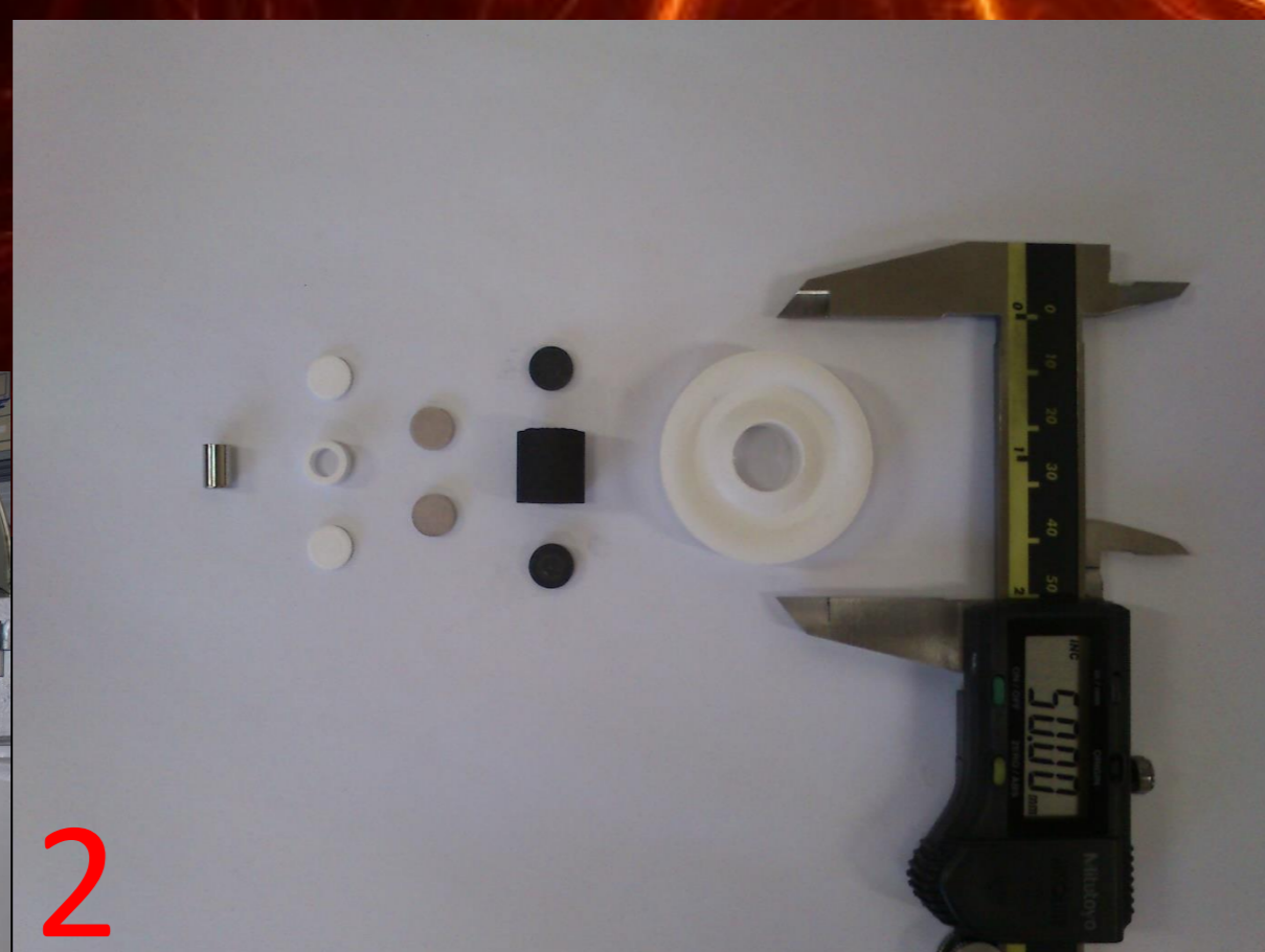
Imagem 2: Componentes das células de reação (da esquerda pra direita): capsula de Pt, componentes de hBN, pastilhas de pirofilita, componentes de grafite e gaxeta de CaCO_2
