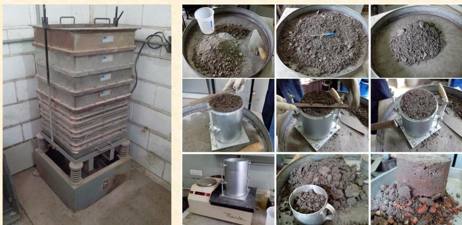
Peneirador mecânico e ensaio de compactação.
