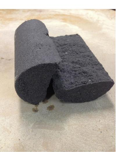
No ensaio de compressão, chegou-se a um resultado similar, porém, com valores de resistência à ruptura mais alta.
